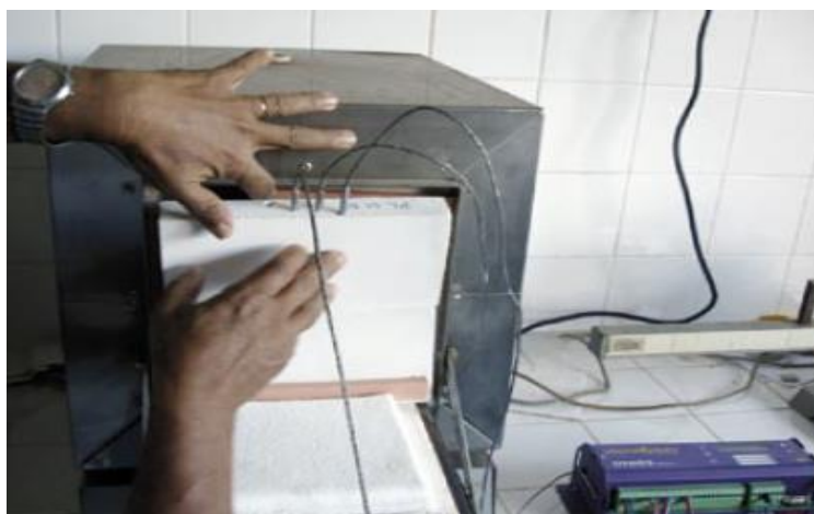
Figura 14 – Ensaio de resistência térmica de elementos pré-moldados de gesso. Fonte: PERES, BENACHOUR, SANTOS (2008).
