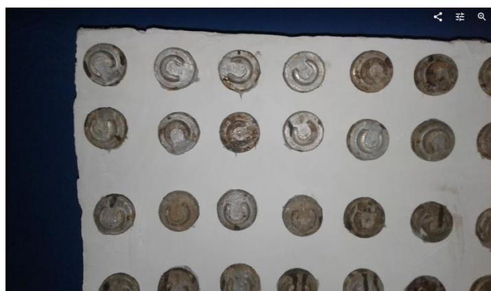
Figura 28 – Corpo-de-prova pronto para ensaio, após a colagem da pastilha metálica para acoplamento no equipamento de tração. Fonte: Autor.
