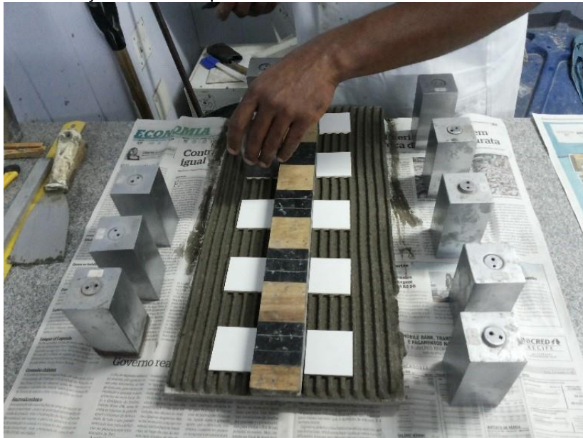
Figura 20 - Colocação da massa padrão de material não deformável sobre os azulejos.
