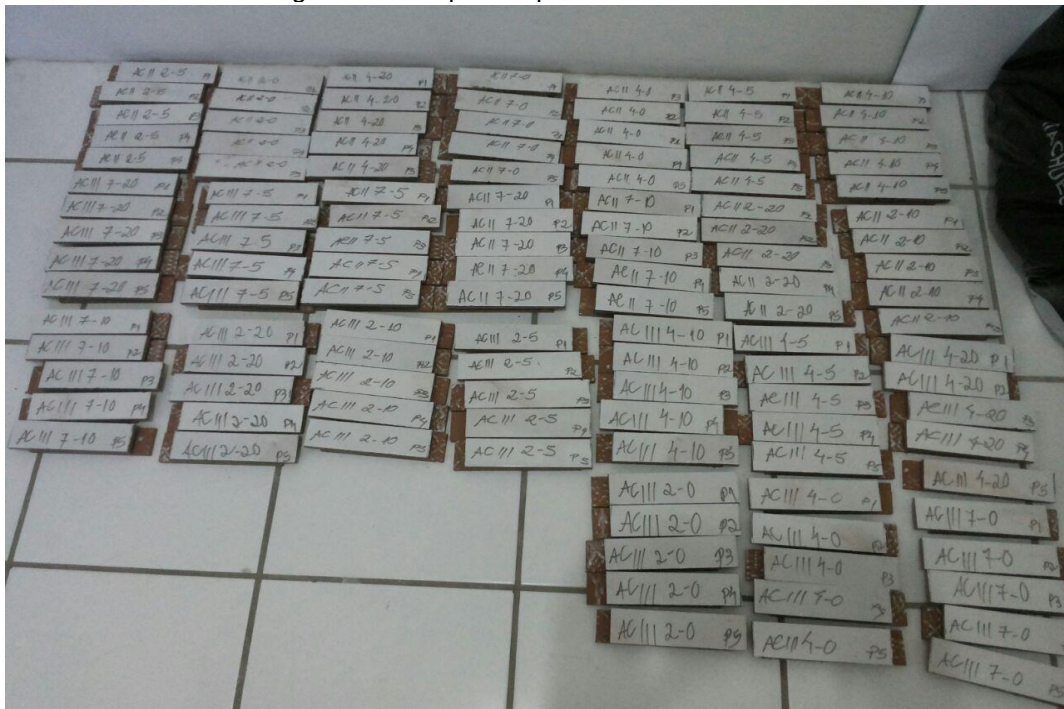
Figura 29 - Corpos de prova do ensaio MMF.
