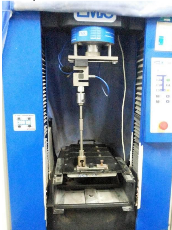
Figura 21 - Ensaio de arrancamento.
