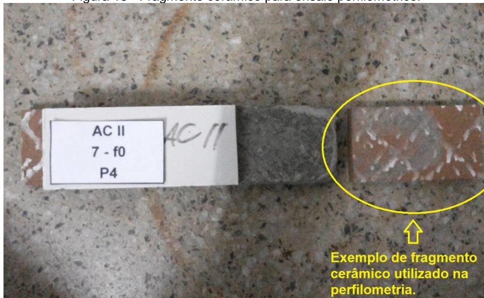
Figura 18 - Fragmento cerâmico para ensaio perfilométrico.
