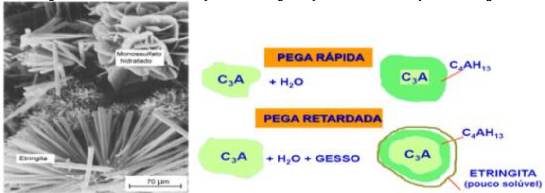
Figura 1 - Estrutura microscópica da Etringita e processo de formação da Etringita.
