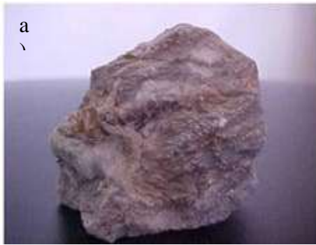
Figura 1 – Variedades do minério gipsita encontradas no Araripe de Pernambuco: a) Pedra ruim; b) rapadura; c) alabastro branco; d) alabastro rosa; e) pedra branca; f) cocadinha
