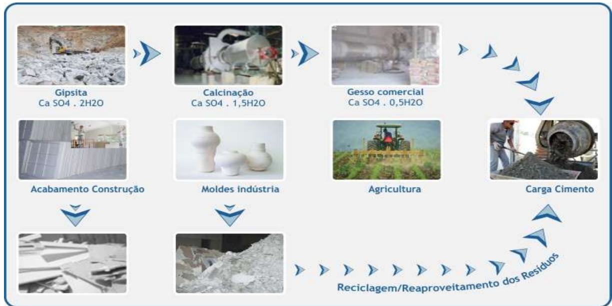
Figura 1 – Processo de Reciclagem do Gesso
