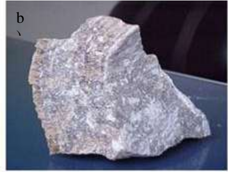
Figura 1 – Variedades do minério gipsita encontradas no Araripe de Pernambuco: a) Pedra ruim; b) rapadura; c) alabastro branco; d) alabastro rosa; e) pedra branca; f) cocadinha
