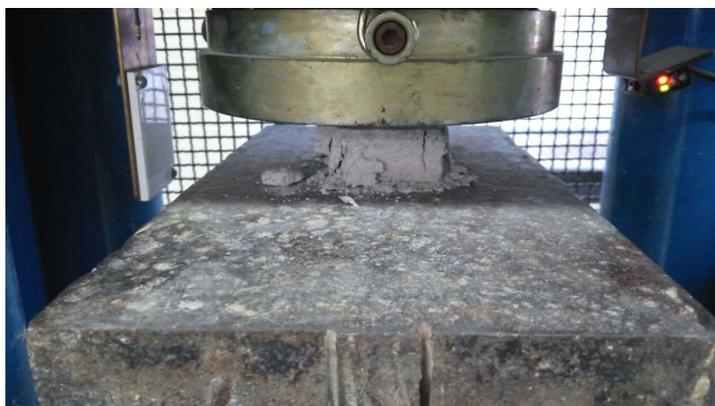
Figura 33 - Ensaio de resistência à compressão nos espaçadores industrializados de argamassa.
