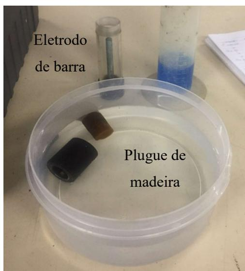
Para preencher o eletrodo de barra, uma solução saturada de sulfato de cobre deve ser preparada. A solução deve ser misturada na proporção de 40 unidades por peso de sulfato de
