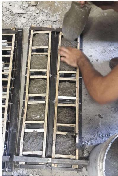
Figura 28 - Acabamento superficial dos corpos de prova após o adensamento.
