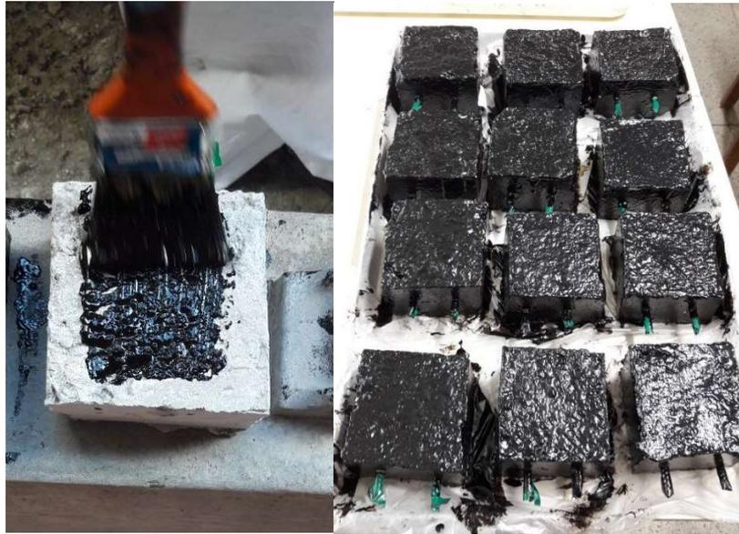
Findando o período de secagem da tinta, foram conectados fios flexíveis à extremidade livre das armaduras, para as medidas dos futuros potenciais de corrosão. Essa conexão foi protegida com fita isolante, conforme a Figura 35.
