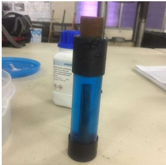
Com o eletrodo de barra (conexão negativa) pronto, acopla-o no CANIN+ (voltímetro), fazendo o mesmo com o eletrodo de conexão positiva, conforme a Figura 49.
