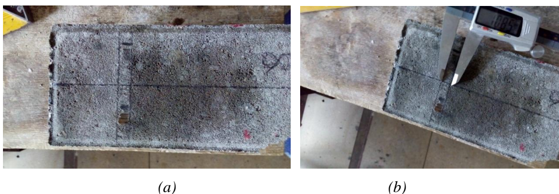
Figura 13. Procedimento de verificação da dimensão da cavidade dos pavers .
