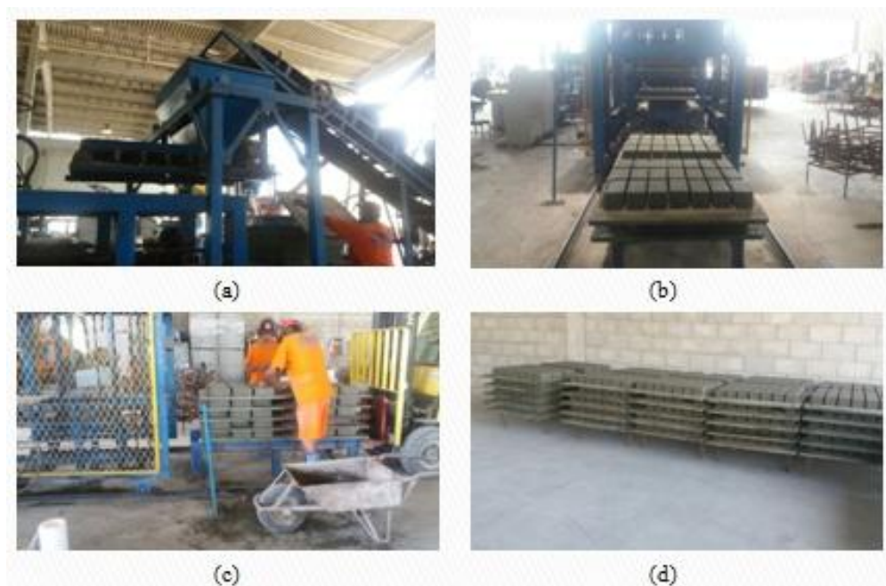
Figura 15. Etapas de fabricação dos pavers (com teores de metacaulim de 0%, 4%, 8% e 10%) para pavimentação estudada nesta dissertação: (a) adição da mistura precursora para prensagem; (b) saída dos pavers do equipamento de prensagem; (c) armazenamento dos pavers e (d) etapa de realização do tempo de cura
