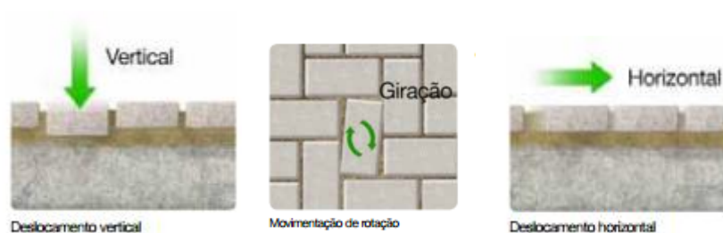
Figura 7. As três possíveis movimentações dos blocos submetidos à ação de forças no pavimento (ABCP 2010)
