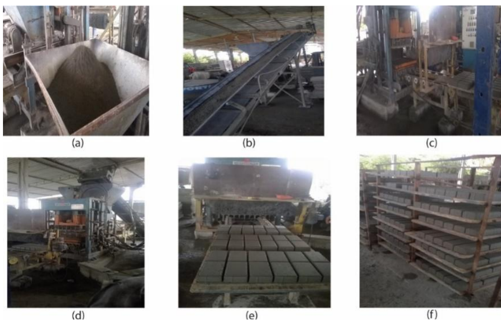
Figura 10. Etapas de fabricação dos pavers de concreto (com teores de 0%, 10%, 15%, 20%, 25% e 30%) para pavimentação estudada nesta dissertação: (a) preparação das misturas precursoras; (b) adição da mistura precursora para prensagem; (c) prensagem dos pavers de concreto; (d) saída das peças de concreto do equipamento de prensagem; (e) armazenamento dos pavers e (f) etapa de realização do tempo de cura.
