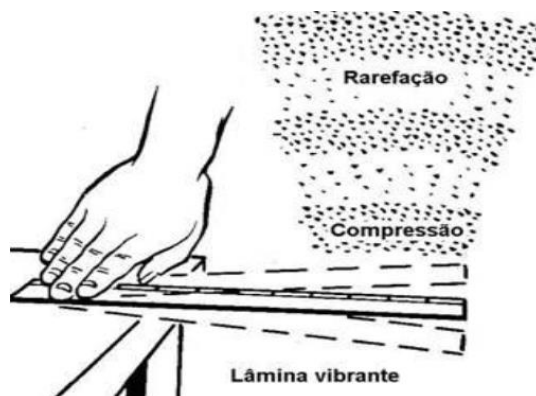
Figura 3 – Corpo sólido vibrando imerso num meio de partículas mostrando regiões de compressão e rarefação.
