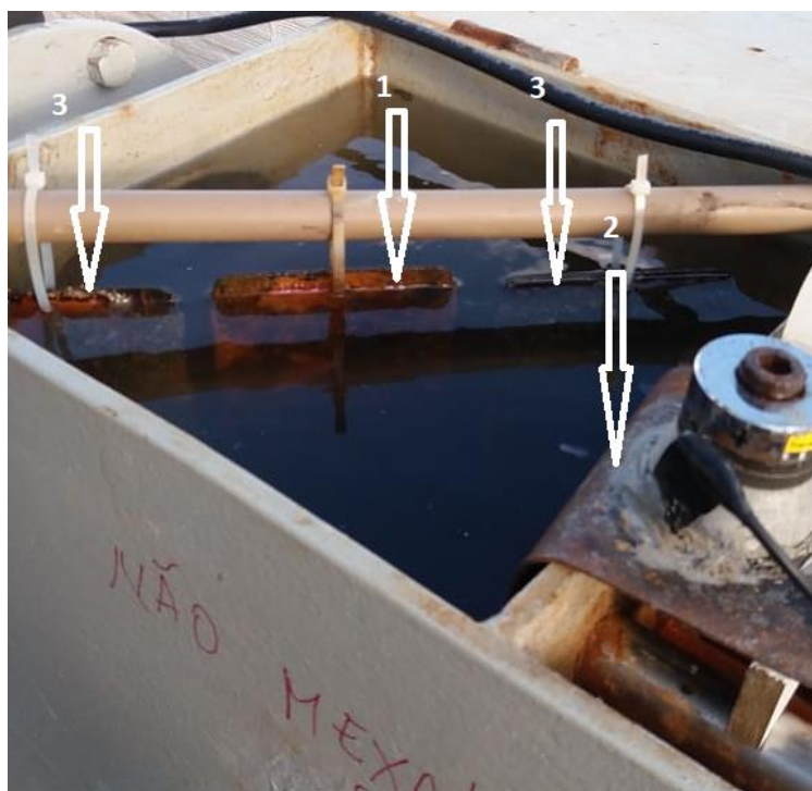
Figura 7 – Vista parcial da parte superior da caixa de água de entrada do protótipo instalado no Catamaran: 1) placa testemunha; 2) placa conectada a um transdutor ultrassônico; 3) placas infestadas de larvas de cracas
