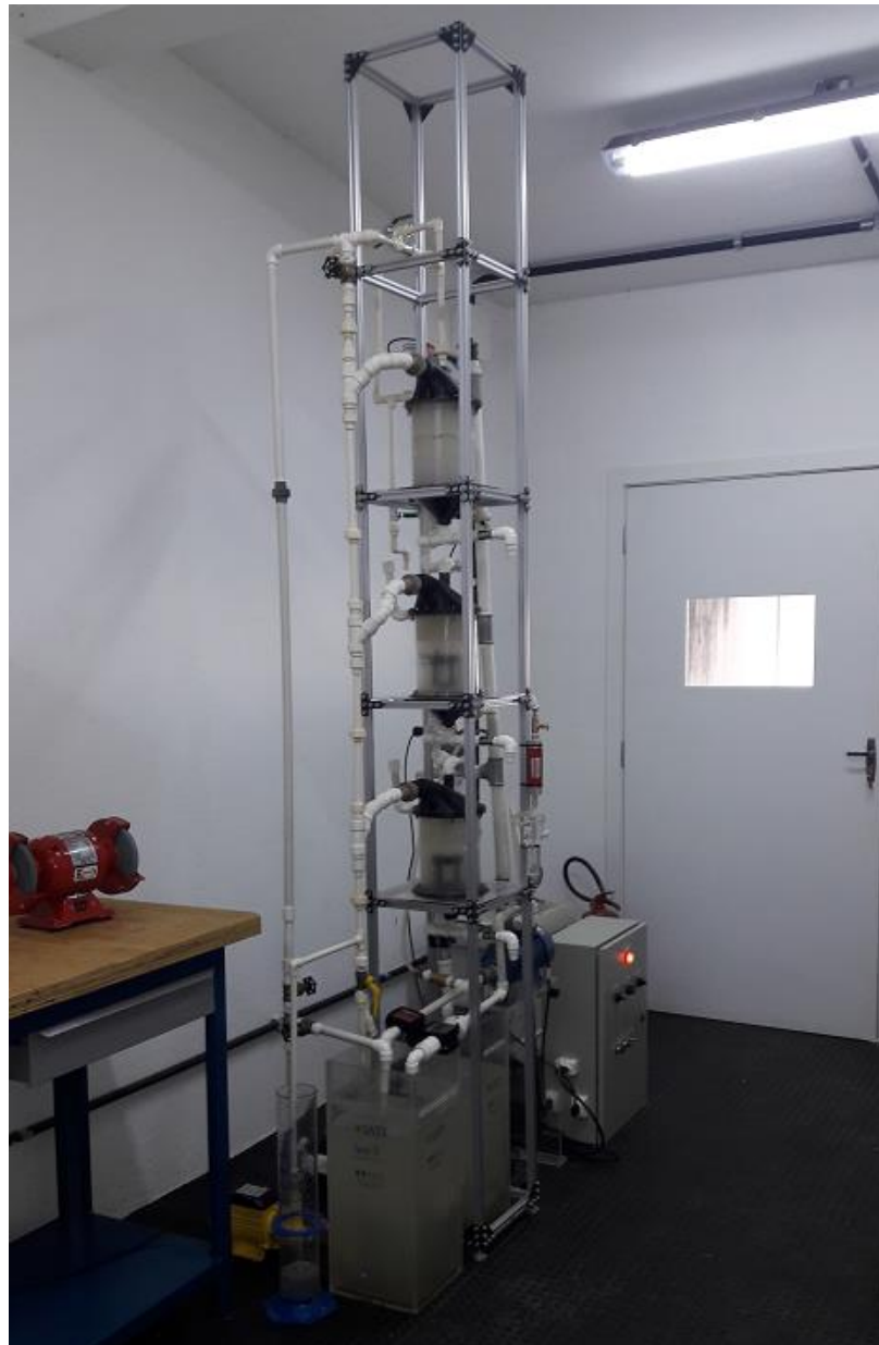
Figura 4 – Torre de saturação induzida em estágios concebida neste trabalho
