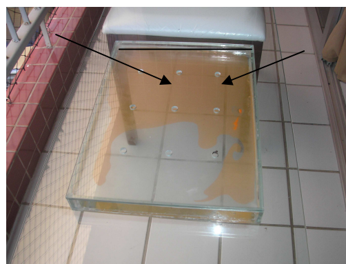
Figura 13 – Visualização da pluma provocada pelo poluente
