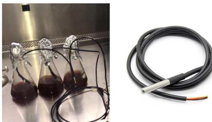
Figura 2. Sensor DS18B20 submerso na fermentação por C. phaeosphora e isolado
