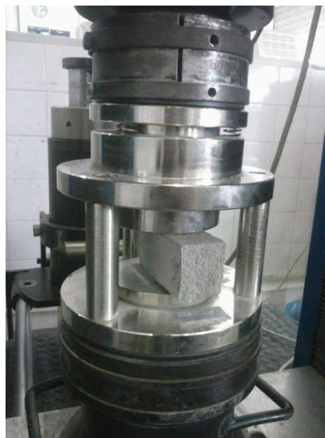
Figura 40- Ensaio de compressão nas barras de argamassa
