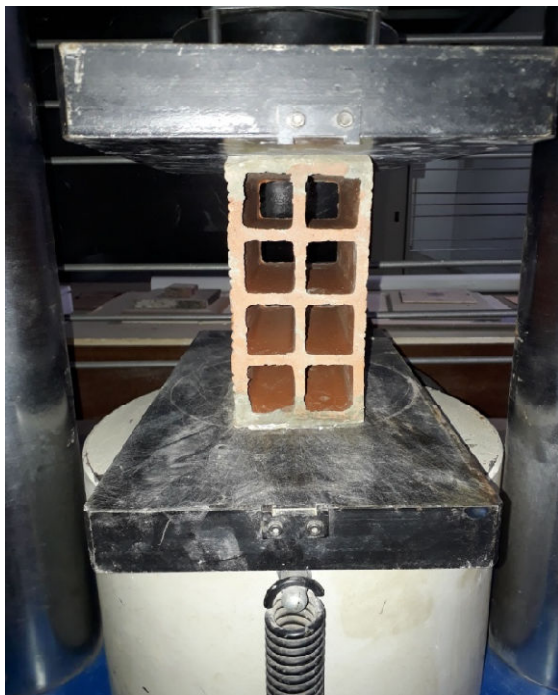
Figura 17- Ensaio de compressão em blocos cerâmicos
