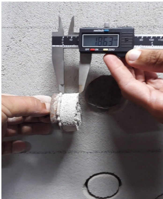
Figura 31 - Verificação da espessura do arrancamento.
