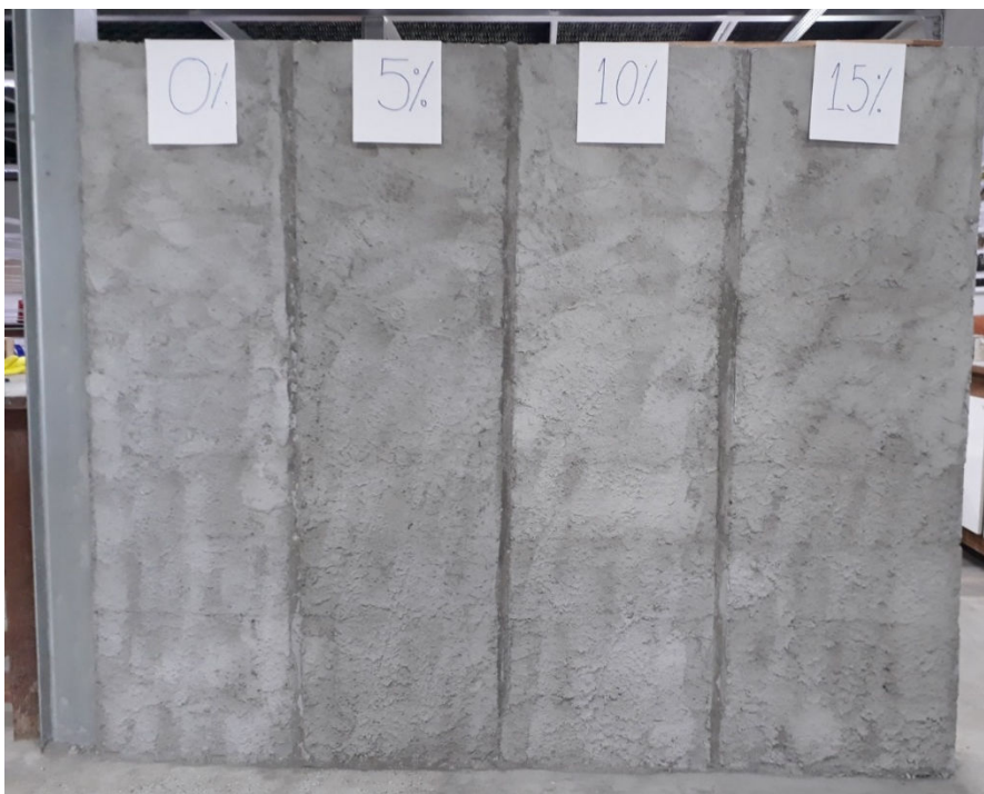
Figura 22: Famílias base blocos de concreto com solução de cal
