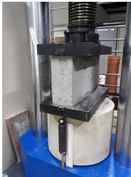
Figura 18 - Ensaio de compressão em blocos de concreto
