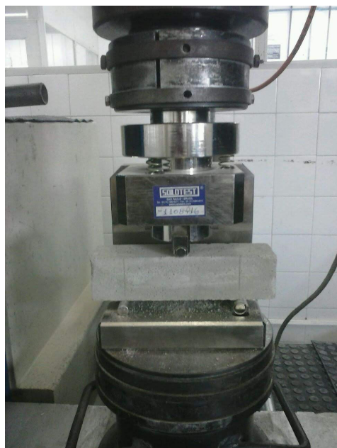
Figura 39- Ensaio de tração na flexão em barras de argamassa
