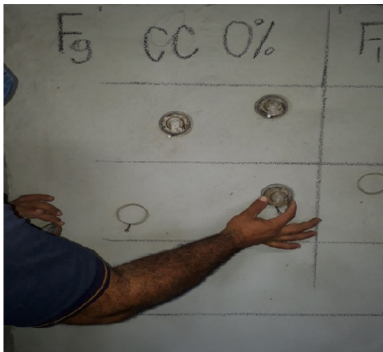
Figura 28: Colagem das placas de aderência
