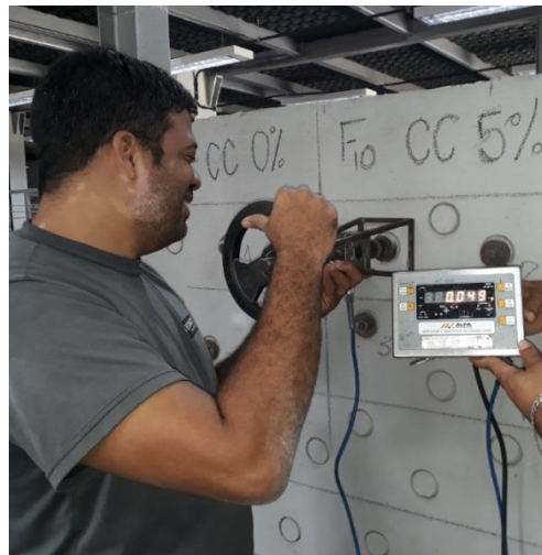
Figura 29: Ensaio de Aderência
