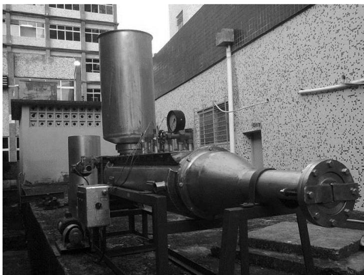
Figura 2 – Fotografia do forno contínuo de elemento móvel helicoidal
