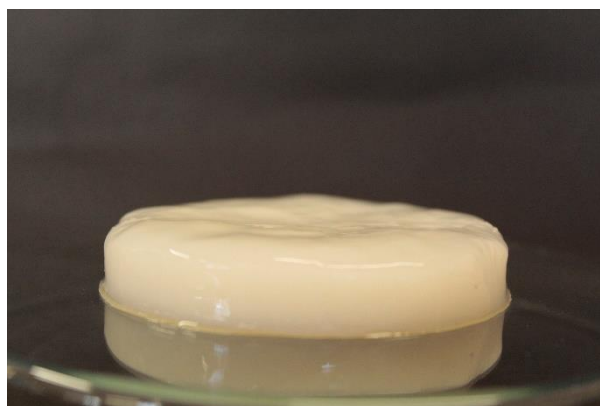
Figura 6 - Membrana de celulose bacteriana com 10 dias de cultivo.
