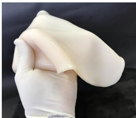
Figura 4 - Celulose Bacteriana produzida em meio alternativo.
