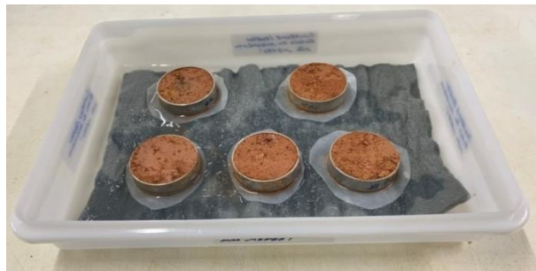
Figura 38 – Anéis de sucção em processo de saturação
