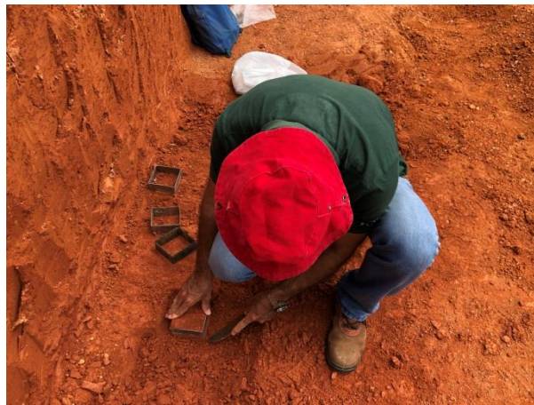
Figura 37 – Moldagem de caixas de cisalhamento
