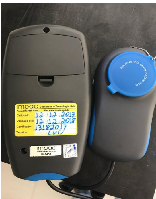
Figura 15 - Calibração do Luxímetro
