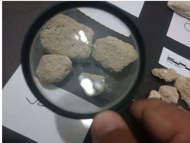
Figura 18 - Argamassa de assentamento da Senzala observada na lupa de 10x
