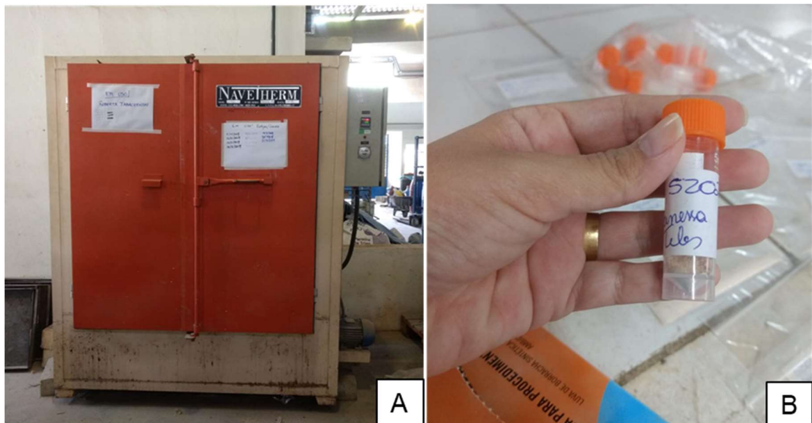
Figura 20 - Estufa do Laboratório de Construção Civil da UFPE utilizada para esterilização dos instrumentos (A) e tubos criogênicos para armazenar as amostras
