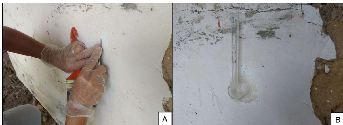
Figura 21 -A - Preparação e limpeza da superfície para aplicação do tubo de Karsten. B - Tubo de Karsten fixado na superfície com massa acrílica
