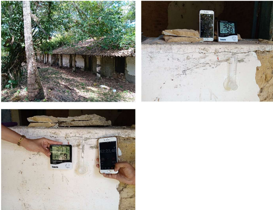
Figura 31 -Local de Fixação do tubo de Karsten na Senzala
