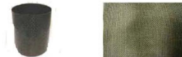
(a) Tubo de resina e Fibras de carbono (b) Folhas de Fibras de carbono
