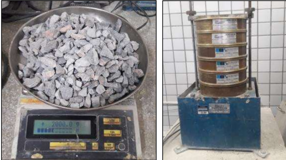
Figura 27: Caracterização Granulometria Brita 19
