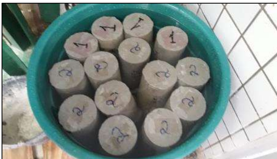
Figura 24: Cura submersa corpos de prova
