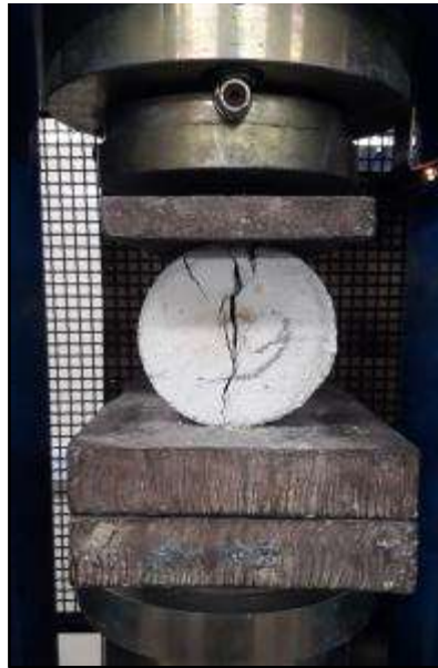
Figura 42: Rompimento de Corpo de Prova por Compressão Diametral.
