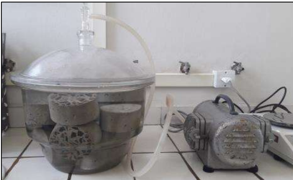
Figura 35: Amostras submetidas ao Vácuo.
