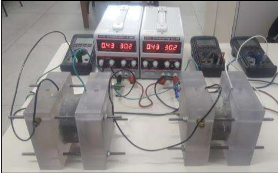
Figura 36: Circuito Ensaio Migração de Íons Cloretos
