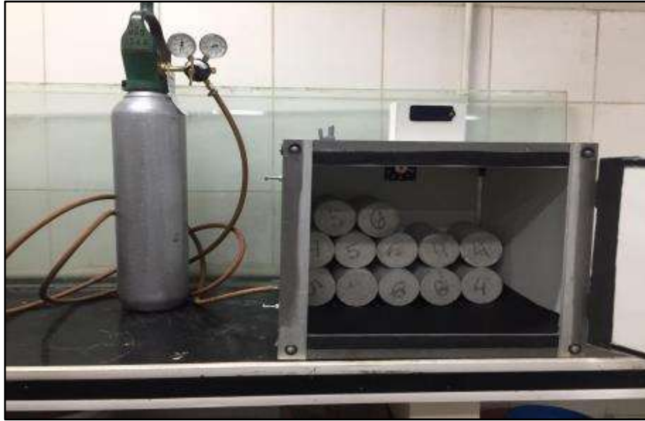
Figura 39: Câmara de Carbonatação
