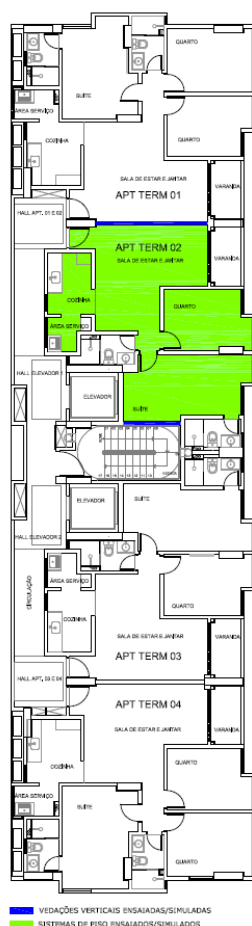
Figura 85 - Planta padrão tipo do imóvel I-4: detalhe dos locais de realização dos ensaios
