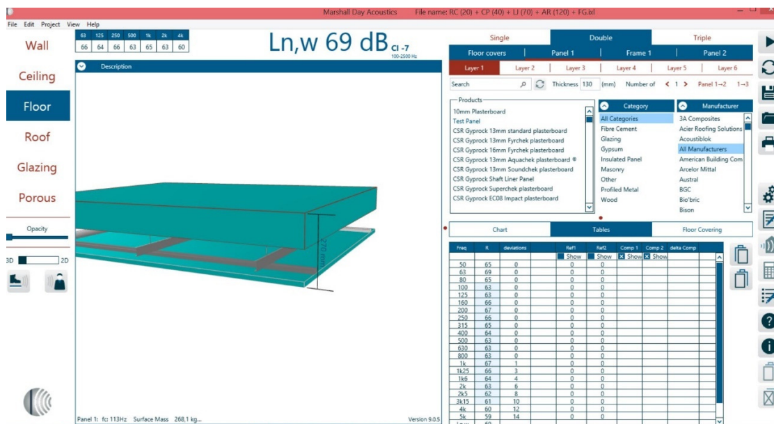
Figura 60 - Nível de pressão sonora de impacto padrão de piso/teto calculado pelo Insul – I-9
