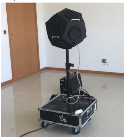
Figura 43 - Fonte emissora de ruído
