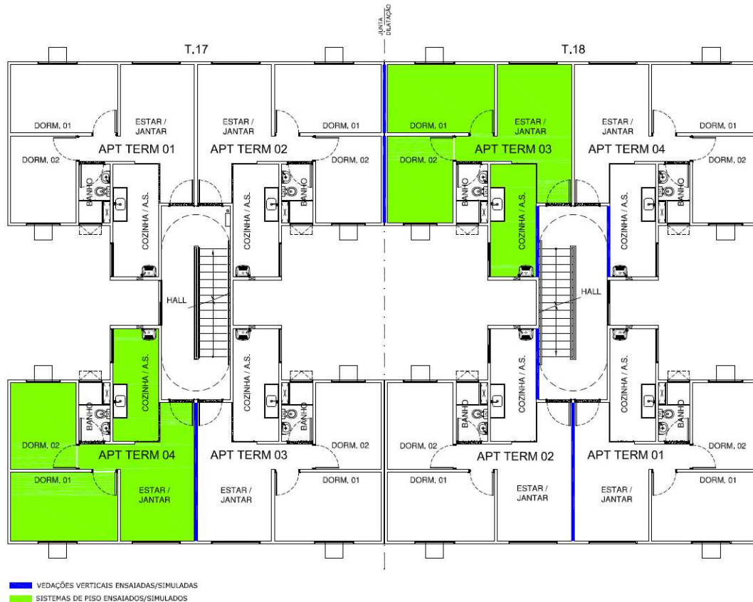
Figura 101 - Planta padrão tipo do imóvel I-12: detalhe dos locais de realização dos ensaios
