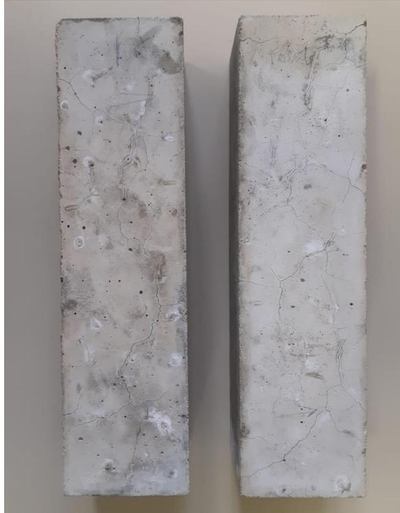
Figura 18: Corpos de prova da família F4 ao final do ensaio
