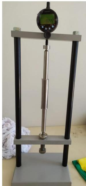
Figura 8: Barra-padrão encaixada ao suporte do relógio comparador
