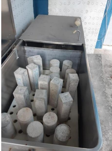
Figura 11: Corpos de prova acomodados no tanque
