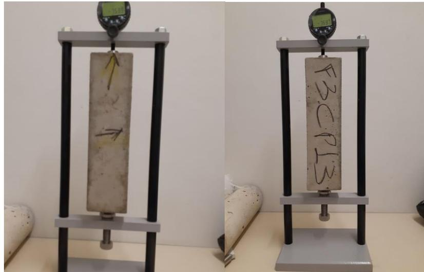
Figura 12: Leitura do comprimento com o deflectometro
