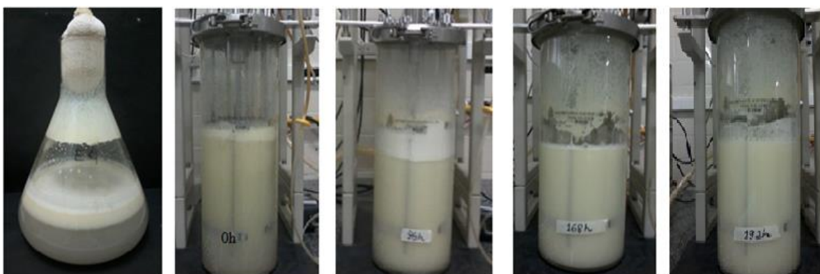
Figura 5 - Formação de biofilme em escala de frasco de Fernbach de 2.8.L e em escala de biorreator bancada de 5 L, durante processo de biodegradação de óleo diesel por C. lipolytica UCP 0988, em água do mar suplementada com sulfato de amônio e fosfato monobásico de potássio.
