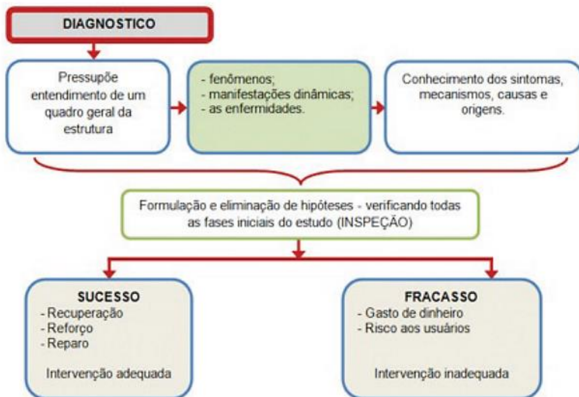
Figura 30 - Esboço das etapas e da importância de um diagnóstico nas estruturas com manifestações patológicas.
