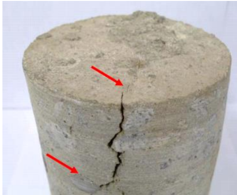
Figura 39 - Análise interna: lesão se propaga até o aço
