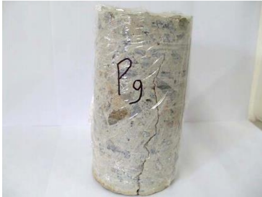
Figura 37 - Testemunho embalado em papel filme
