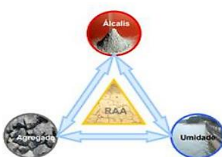
Figura 13 - Fatores condicionantes da RAA
