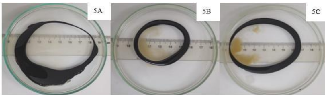
Figura 5 - Estabilidade do biossurfactante após modificação térmica avaliada pelo teste de deslocamento de óleo: 5A (28 cm 2 /30°C); 5B (12,56 cm 2 /70°C); 5C (33,16 cm 2 /80°C)
