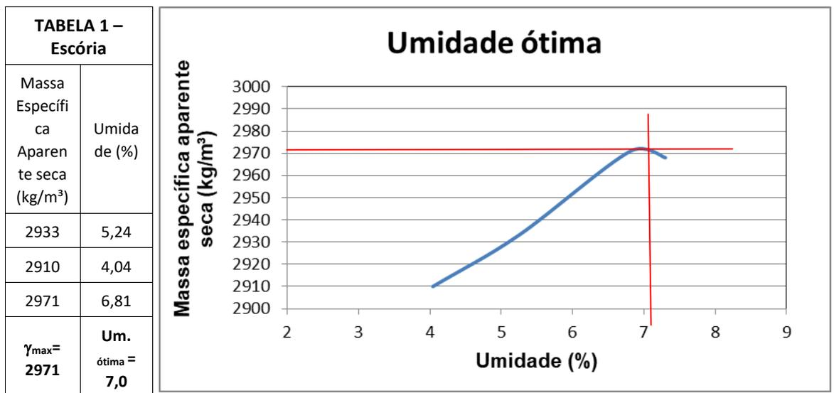
Com a definição das *Massas Específicas Aparentes Secas Máximas (M.E.A.Max.)* em função das *Umidades Ótimas (U.O.)*, foram definidos o *Índice de Suporte Califórnia (I.S.C.)* e a *Expansão Volumétrica (E.V.)* da amostra de escória **Escória**. A *Tabela 2* apresenta os resultados obtidos.
