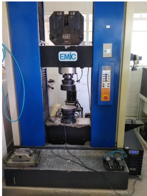
Figura 16 – Prensa de compressão axial para corpos de prova
