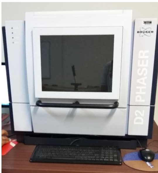
Figura 11 – Diafratômetro de Raio-x modelo D2 PHASER
