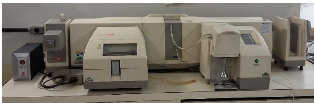
Figura 10 – Analisador granulométrico a laser modelo Mastersizer 2000
