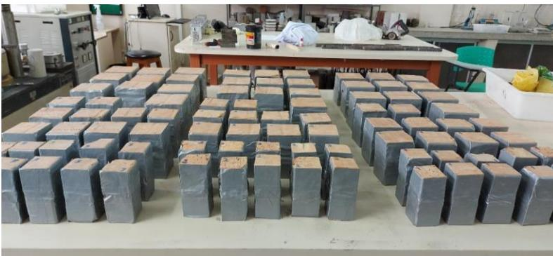
Depois de impermeabilizados, os corpos de prova foram mantidos em local com temperatura ambiente até o momento do ensaio de absorção. Devido à higroscopicidade dos tijolos cerâmicos, os corpos de prova foram colocados em estufa por 48 horas a 50 °C e logo após foram acondicionados em local com temperatura ambiente para resfriamento por 72 h, antes da realização de cada ensaio.
