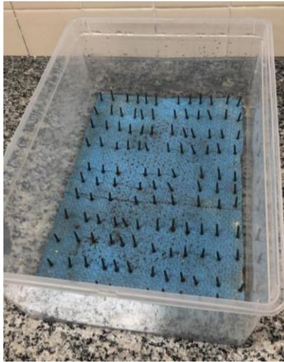
Na face lateral do recipiente foi feita uma marcação para identificar e controlar a altura da lâmina d'água em que os corpos de prova foram parcialmente imersos, com alturas de 5 mm a 10 mm acima da base dos espécimes.
