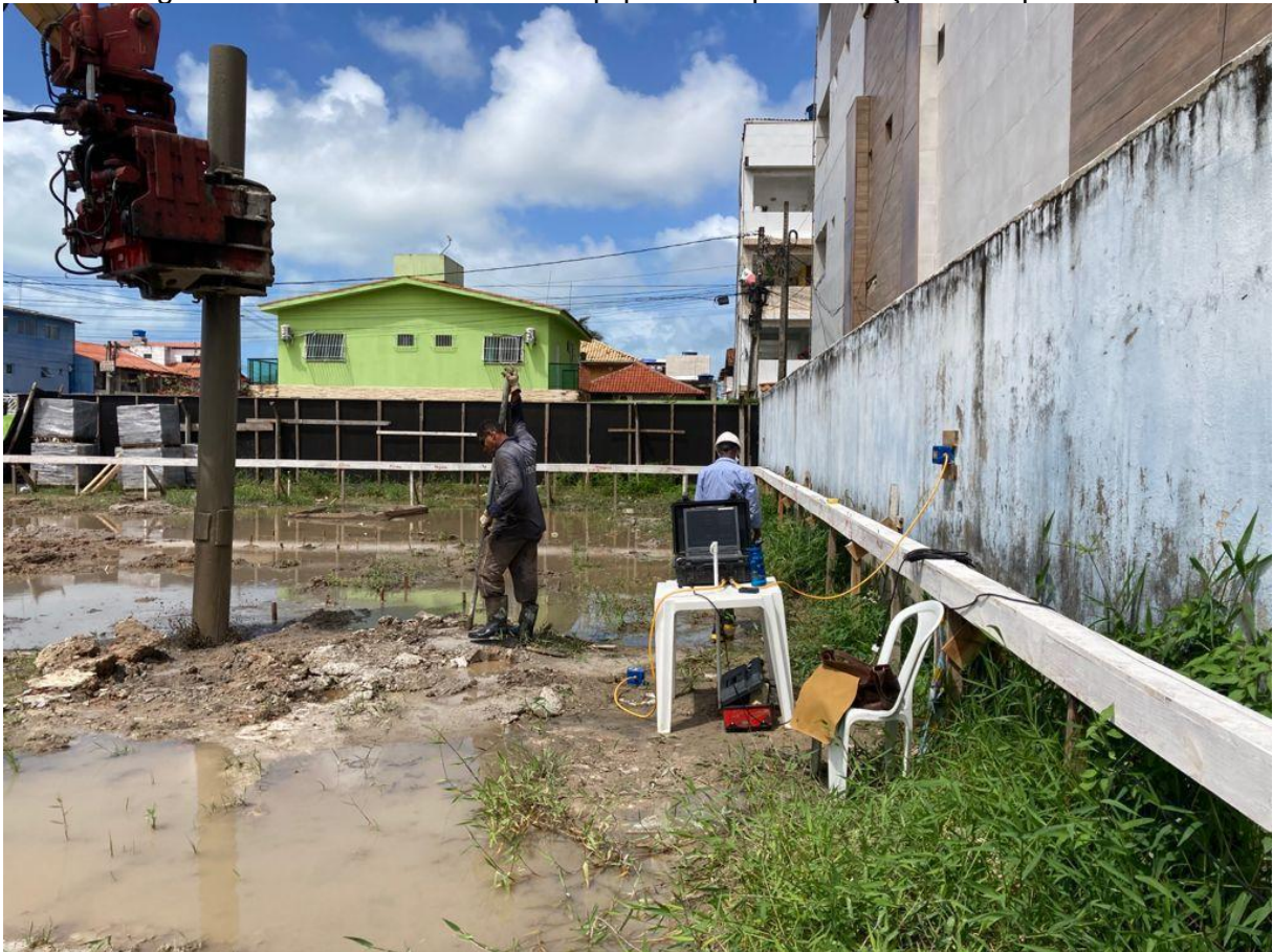
Figura 38 – Posicionamento do equipamento para medição na sapata P57
