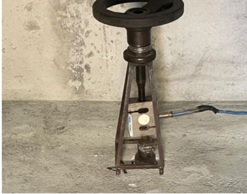
Figura 49: Dinamômetro utilizado durante o ensaio de arrancamento
