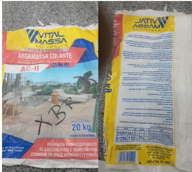
Figura 43: Argamassa VitaMassa tipo AC II e suas características de fabricante
