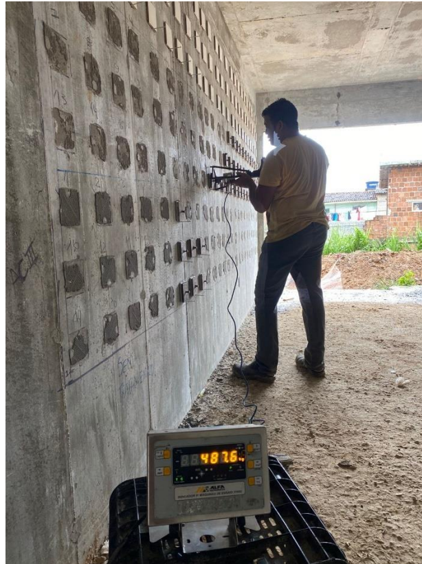
Figura 52: Dinamômetro acoplado registrando os valores de resistência de aderência
