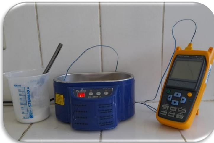
Figura 2: Acompanhamento de temperatura da suspensão resíduos de gesso-água para determinação do tempo adequado de ultrassonicação
