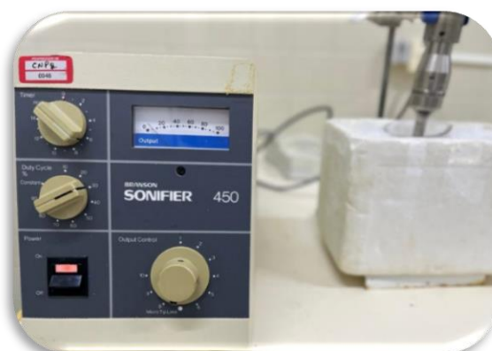
Figura 2 – Preparação dos resíduos de poda para biodisponibilização de açúcares fermentáveis
