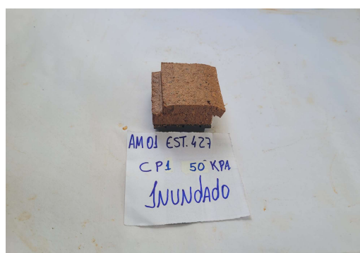
Figura 45 – Amostra 01 Desmoldada – umidade saturada
