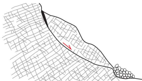
Figura 28 – Deslizamento rotacional em maciço rochoso
