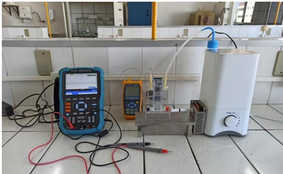
Figura 3: Protótipo acompanhado de instrumentação na realização de experimentos de eletrólise alcalina sem e com a ação de eletrodo ultrassônico na produção laboratorial de hidrogênio verde.
