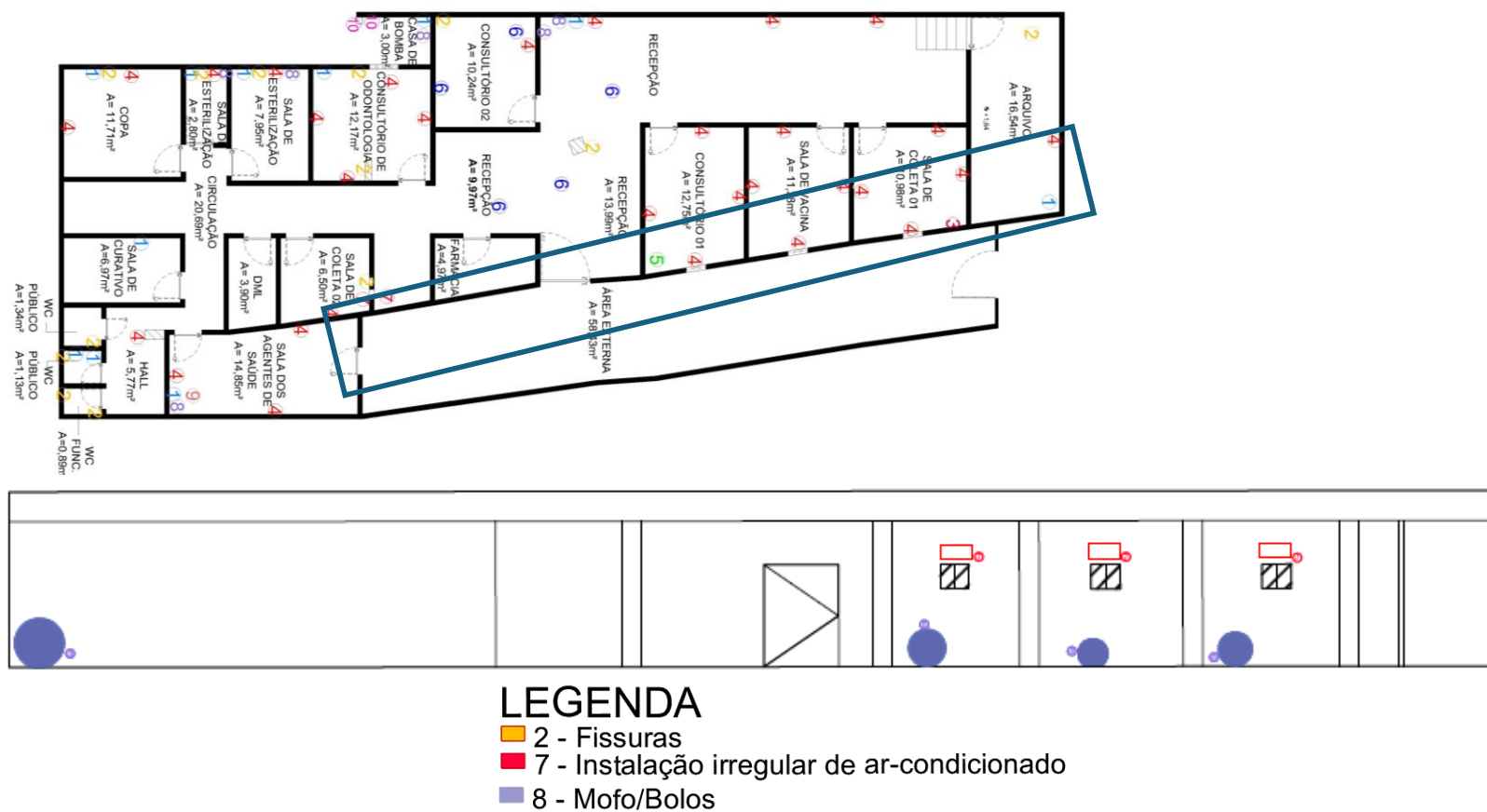
Figura 16 - Mapa de Danos da UBS Ilha do Maruim da Fachada lateral
