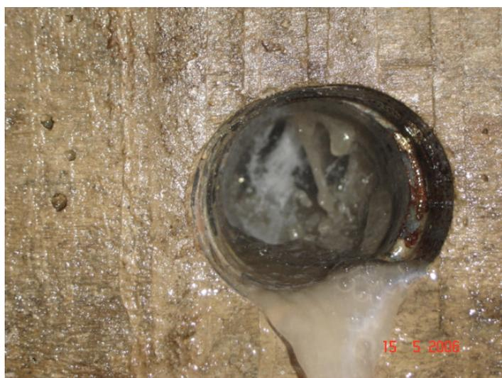
**Figura 5.40 – Saída d'água após um período de lavagem das trincas.**
