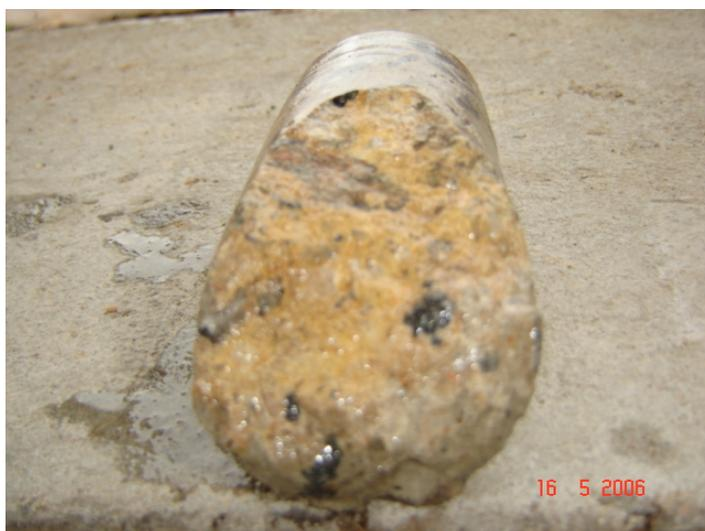
**Figura 5.30 – Indicação do final da trinca através do testemunho extraído.**
