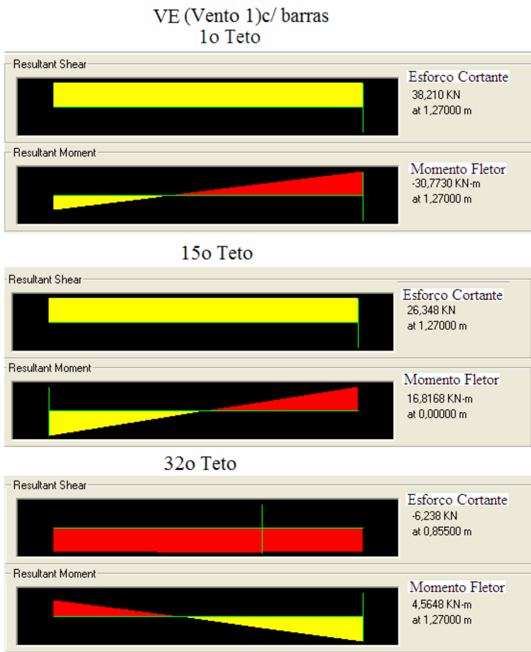
Figura 4.23 - Esforços na viga VE, no pórtico com barras equivalentes
