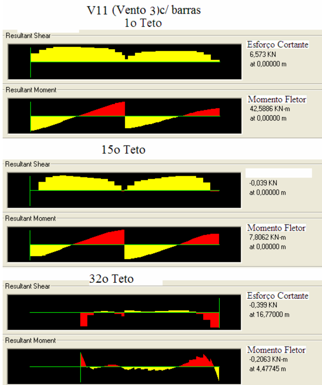
Figura 4.21 - Esforços na viga V11, no pórtico com barras equivalentes
