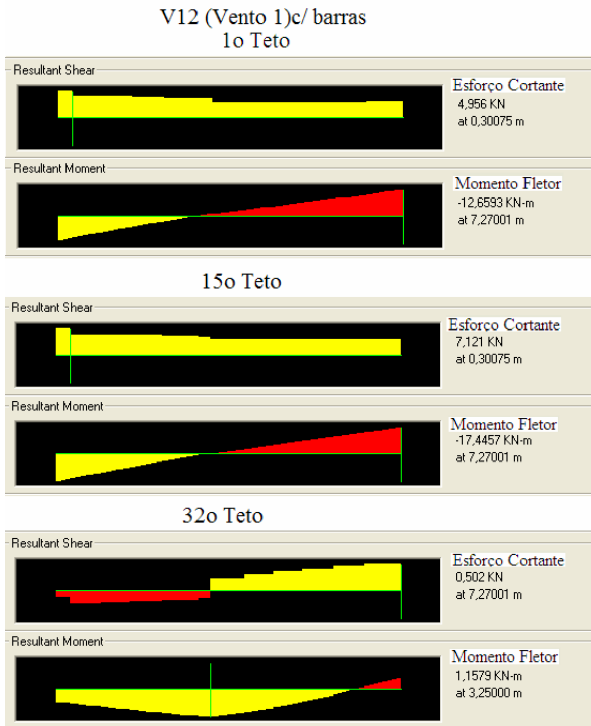
Figura 4.22 - Esforços na viga V12, no pórtico com barras equivalentes
