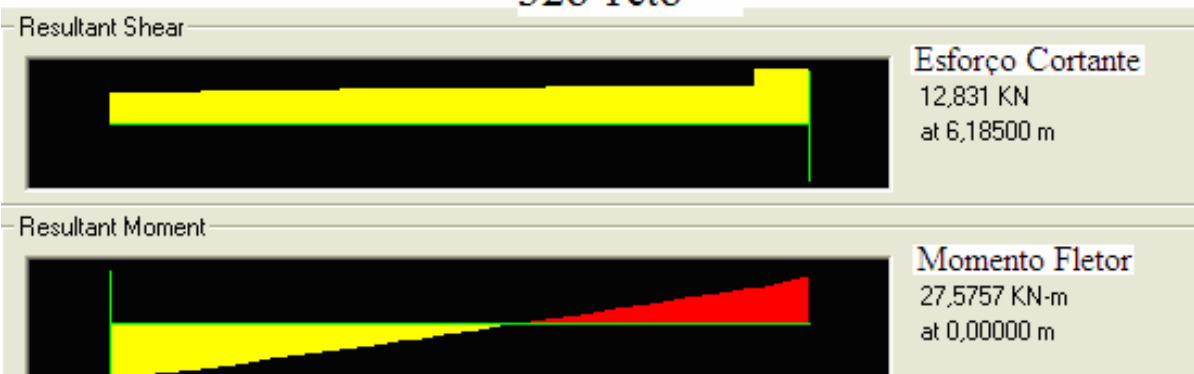
Figura 4.20 - Esforços na viga V4, no pórtico com barras equivalentes
