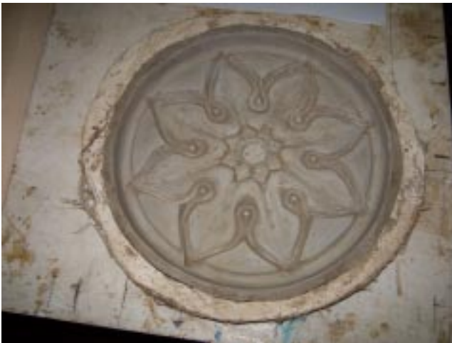
Figura 3.49: Produção das formas, das figuras e adereços em borracha de silicone, permitindo assim maior precisão nos detalhes.
