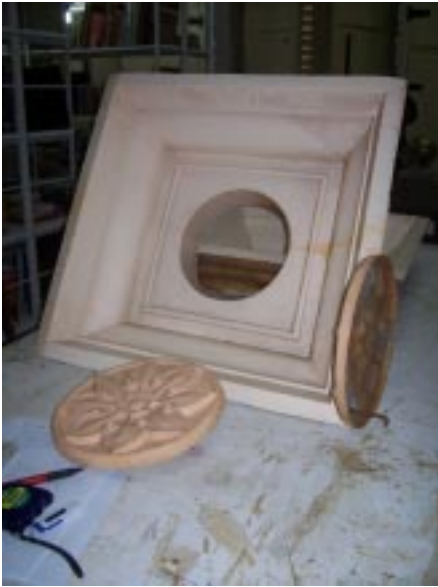
Figura 3.50 e 3.51: conjunto escultórico em fibra de vidro e resina de poliéster e perspectiva do conjunto.
