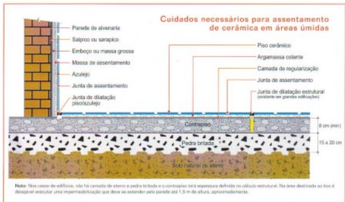
Figura 3.39: detalhe de execução de pisos em áreas molhadas.
