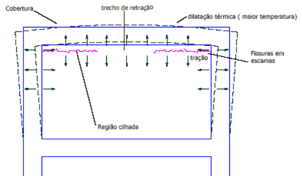
Deformação térmica da cobertura
