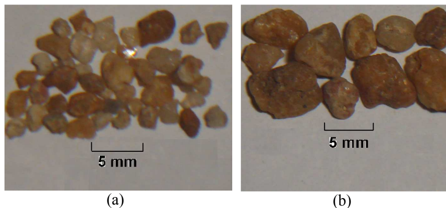
Figura 4.12: Imagens adquiridas através da lupa da fração retida na peneira de malha 1,2 mm (a) e 2,4 mm (b)
