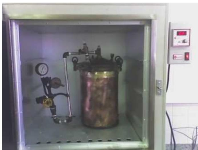
Figura 20 - Estufa com controle digital de temperatura utilizada como fonte de calor para reação de desidratação térmica que ocorre no forno-autoclave
