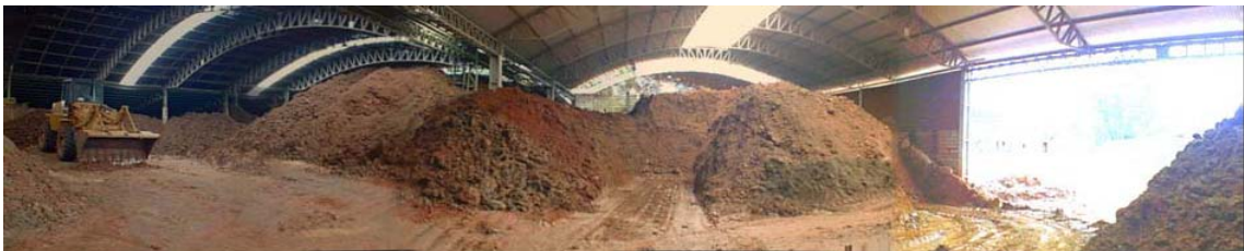
Figura 3 – Depósito de argilas em uma indústria de blocos cerâmicos. Fonte: MANFREDINI (2003)
