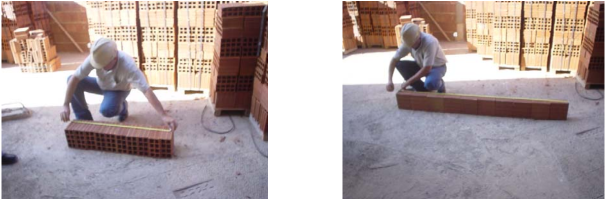
Figura 20 - Inspeção de blocos para características geométricas conforme a NBR 15270-1: 2005
