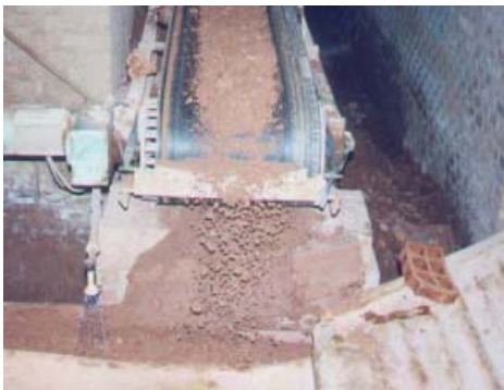
Figura 4C – Fase de amassamento e mistura Fonte: MANFREDINI (2003)
