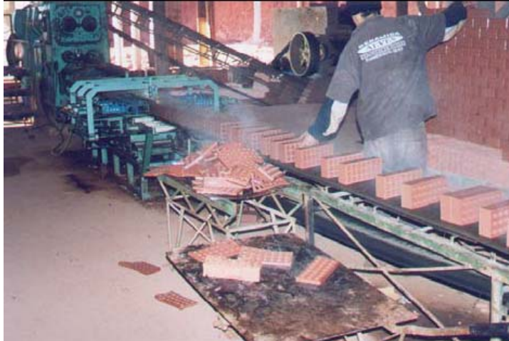
Figura 5 - Fase de extrusão automatizada para fabricação do bloco cerâmico. Fonte: MANFREDINI (2003)
