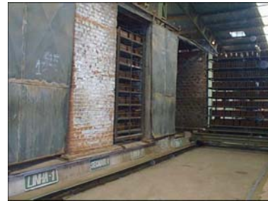
Figura 6B - Secagem artificial em estufa dos blocos cerâmicos Fonte: MANFREDINI (2003)
