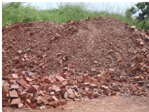
Figura 26 - Resíduos gerados na queima de blocos cerâmicos da indústria Y
