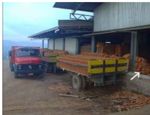
Figura 15 - Perdas de blocos no armazenamento Fonte: MANFREDINI (2003)
