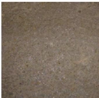
Figura IV.6 – Vista ortogonal da pastilha de concreto convencional.
