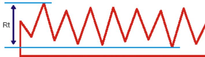
Figura III.15 – Esquema simplificado de rugosidade total (<http://myspace.eng.br/eng/rugosid.asp>)
