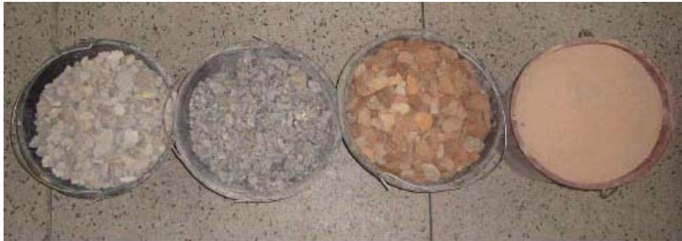
Figura III.5 – Material de RCD já com suas devidas proporções de mistura.
