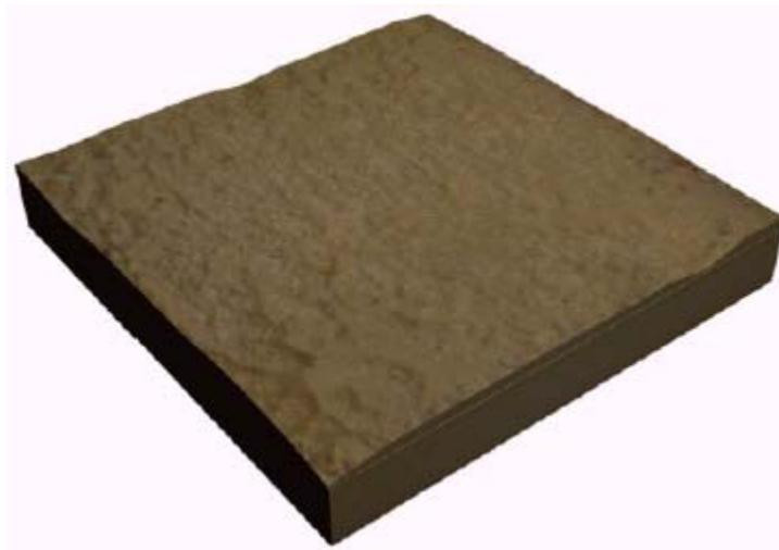
Figura IV.8- Representação da rugosidade pelo Software 3D STUDIO após o mapeamento do concreto com agregado reciclado de construção e demolição-RCD.
