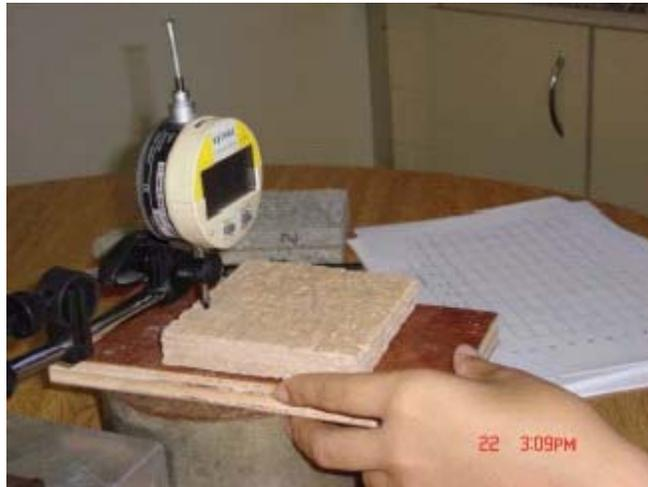
Figura III.13 - Mapeamento de superfície de concreto RCD por um defletrômetro digital.
