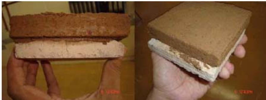
Figura III.3 – Corpo de prova de concreto RCD, submetido ao teste de Cisalhamento.
