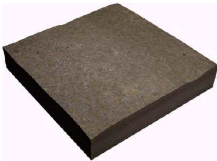
Figura IV.5- Representação da rugosidade pelo Software 3D STUDIO após o mapeamento do concreto convencional.
