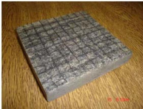
Figura III.12 – Traçado em rocha objetivando medir a profundidade da superfície.
