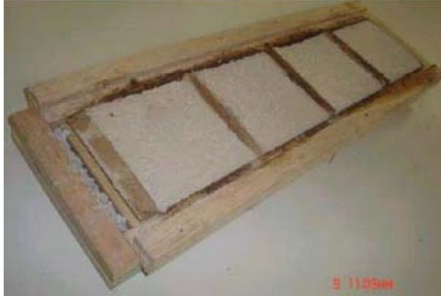
Figura III.11 - Concreto de agregado RCD moldado em forma de madeira
