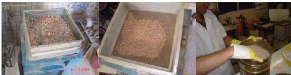
Figura III.7 – Execução do processo de peneiramento segundo norma NBR-7217
