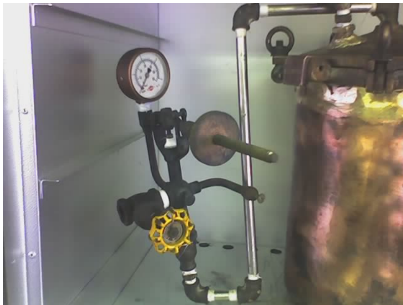
Figura 3.4 - Mecanismo de ajuste automático da pressão
