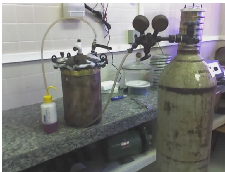
Figura 3.5 - Teste de hermeticidade do arranjo experimental
