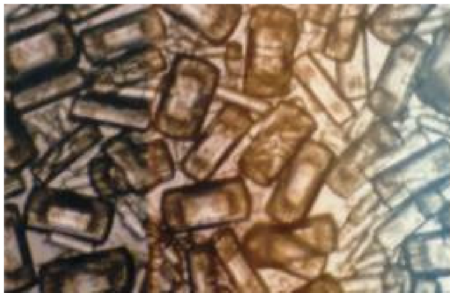
Figura 1.1 - Micrografia Mostrando Cristais Formados na Produção do Gesso Alfa
