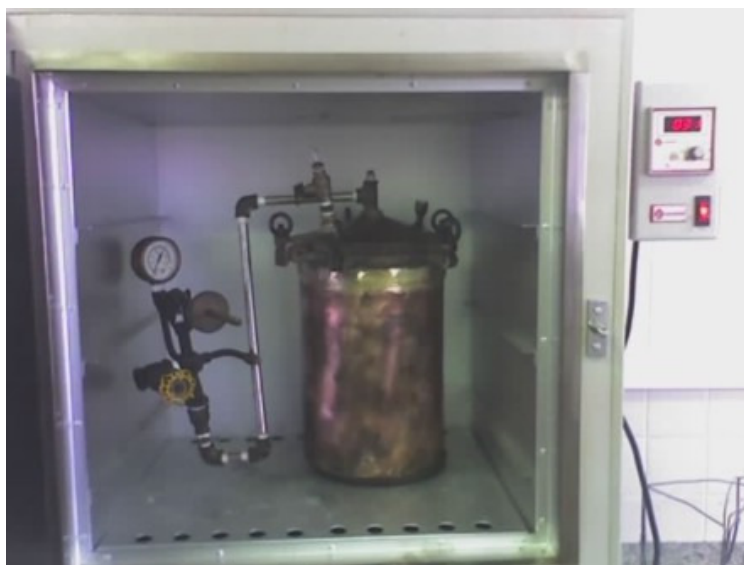
Figura 3.2 - Estufa com controle digital de temperatura utilizado como fonte de calor para reação de desidratação térmica que ocorre no forno
