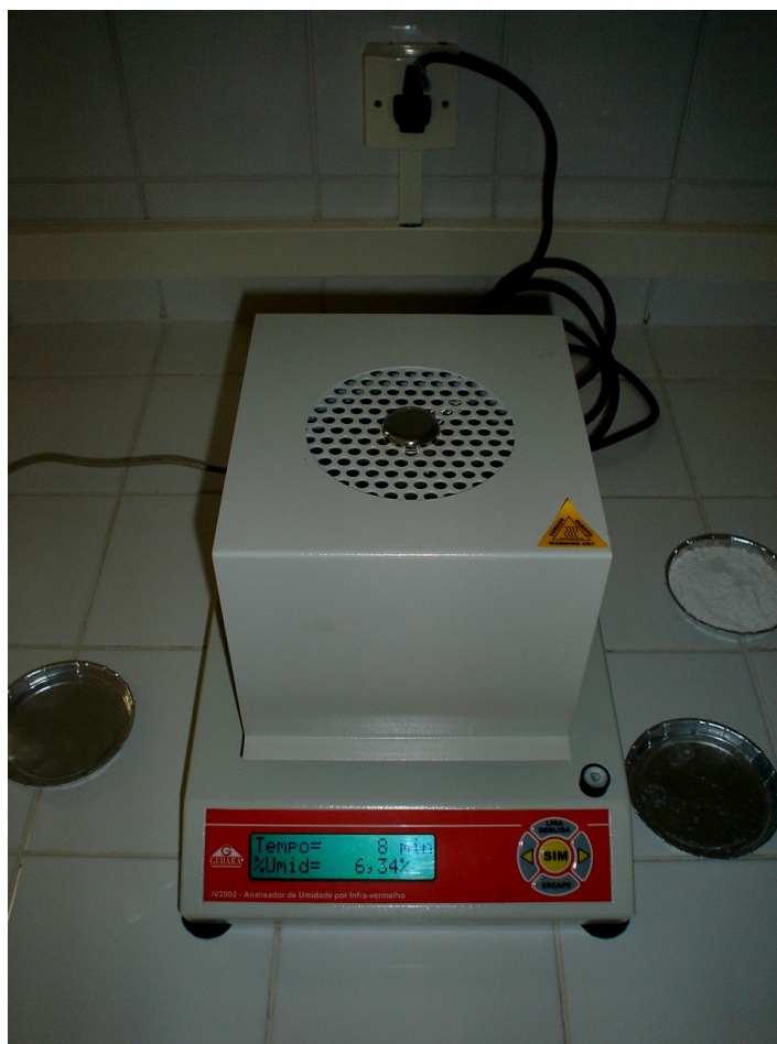
Figura 4.4.3 - Analisador de umidade por técnica de radiação por infra-vermelho
