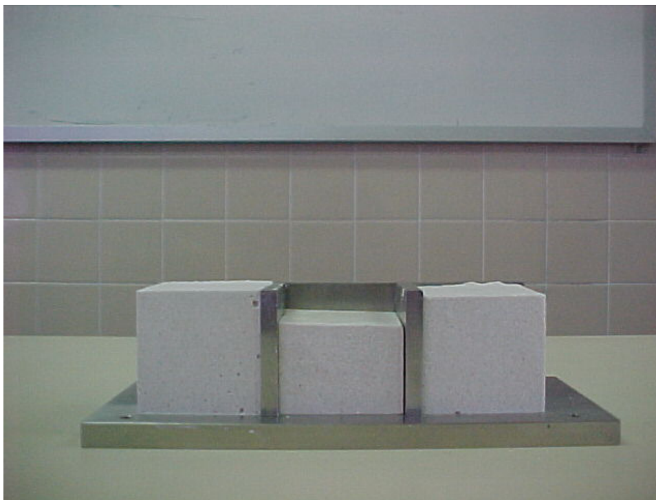
Figura 3.8 - Vista frontal corpos-de-prova desmoldados, confeccionados a partir de diferentes relações água/gesso
