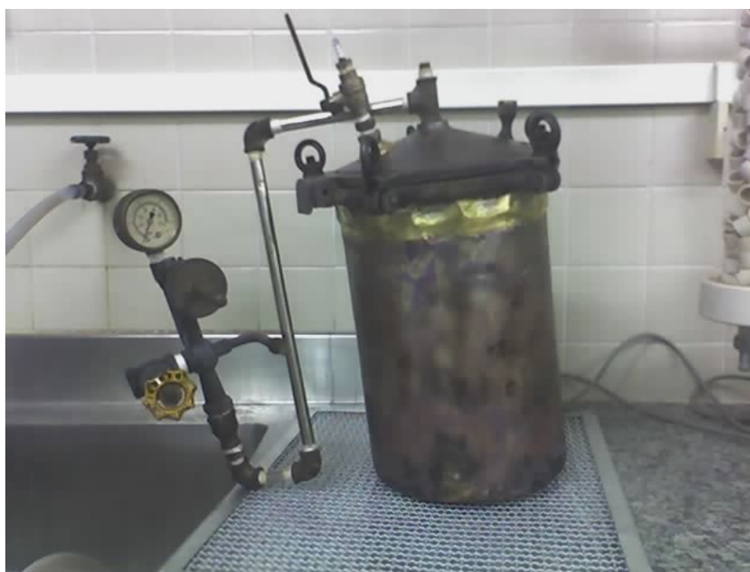
Figura 3.1 – Reator utilizado no arranjo experimental para produção de gesso beta sob pressão acima da pressão atmosférica
