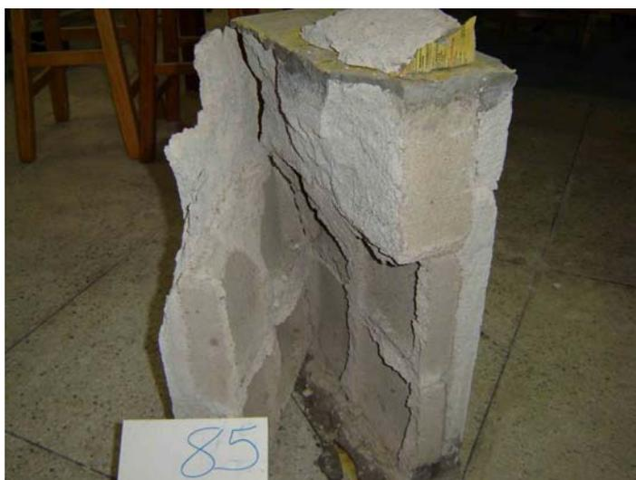
Figura 5. 15 - Prisma desmontado no qual as fissuras o atravessaram
