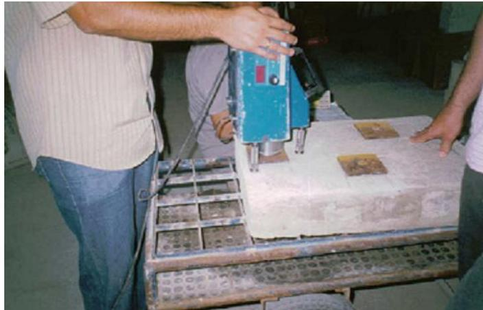
Figura 4. 1 - Ensaio de arrancamento do revestimento dos prismas
