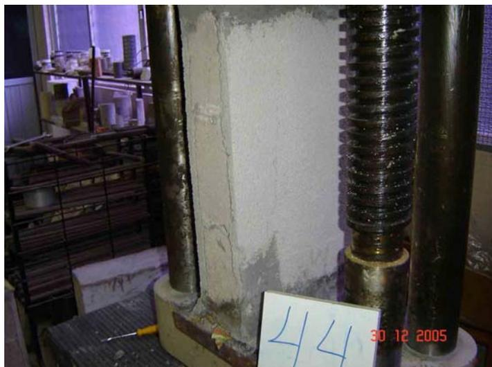
Figura 5. 5 - - Ruptura com fissuras mínimas e sem direção definida nos blocos (Tipo 5)
