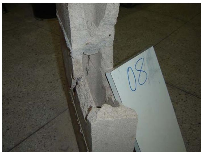
Figura 3. 19 - Prisma ensaiado "desmontado"
