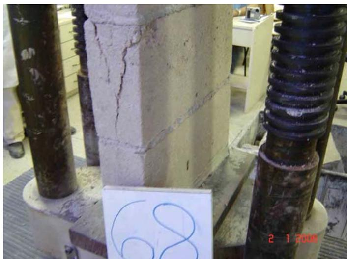
Figura 5. 1 - Ruptura do bloco em "V" (Tipo 1)
