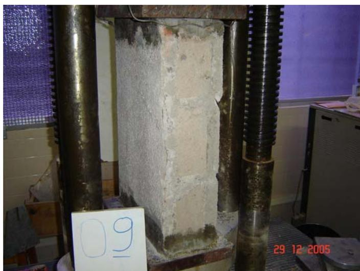
Figura 3. 17 – Chapas de aço usadas para transmissão de esforços na prensa
