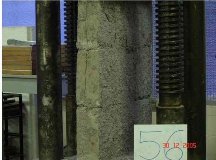
Figura 5. 4 - Ruptura com fissura vertical no meio do bloco (Tipo 4)
