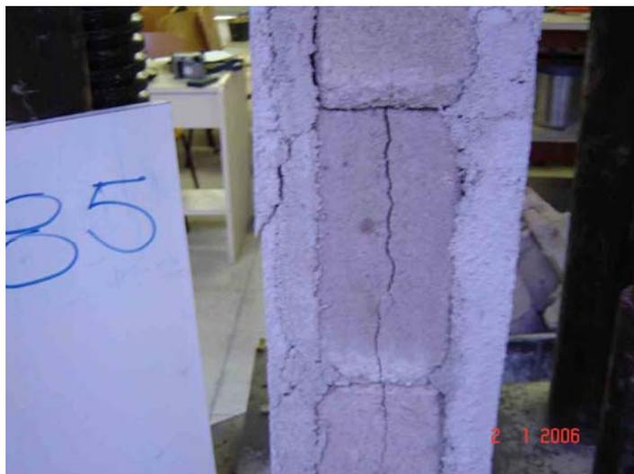
Figura 5. 6 - Ruptura com fissura vertical no meio do bloco e revestimento com fissura diagonal e descolamento (Tipo 4.1)
