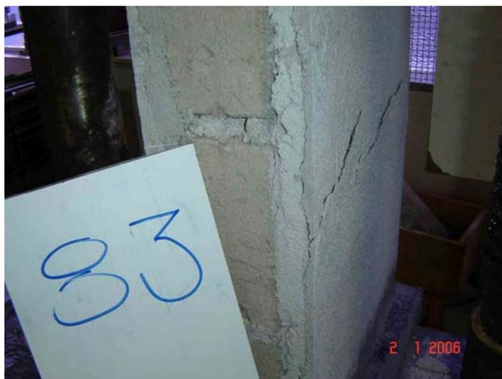
Figura 5. 9 - Ruptura com fissuras mínimas e sem direção definida nos blocos e com descolamento entre camadas da argamassa, com ruptura por flexo-compressão (Tipo 5.4)
