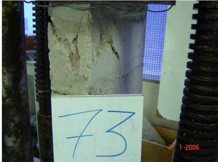
Figura 5. 2 - Ruptura do bloco por múltiplas fraturas em diversas direções (Tipo 2)
