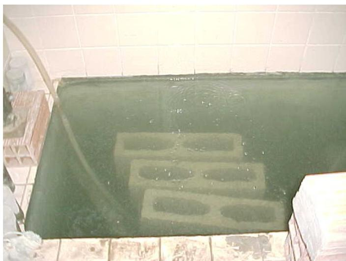
Figura 3. 5 - Blocos de concreto submerso em água por 24 horas
