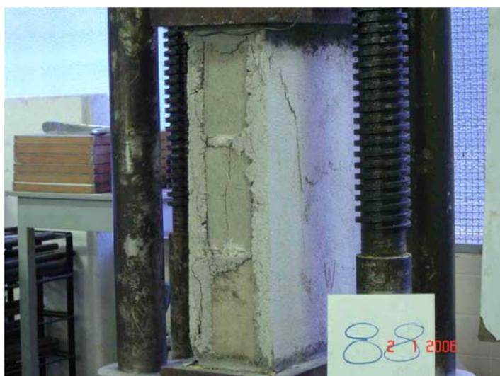
Figura 5. 7 - Ruptura com fissura vertical no meio do bloco e descolamento entre camadas da argamassa (Tipo 4.2)
