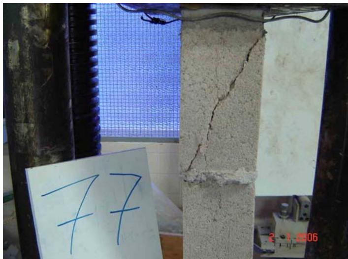
Figura 5. 3 – Ruptura do bloco com fissura diagonal, por cisalhamento (Tipo 3)
