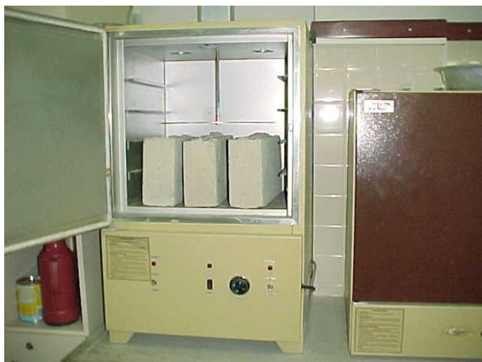
Figura 3. 4 - Blocos de concreto em estufa a 110 °C
