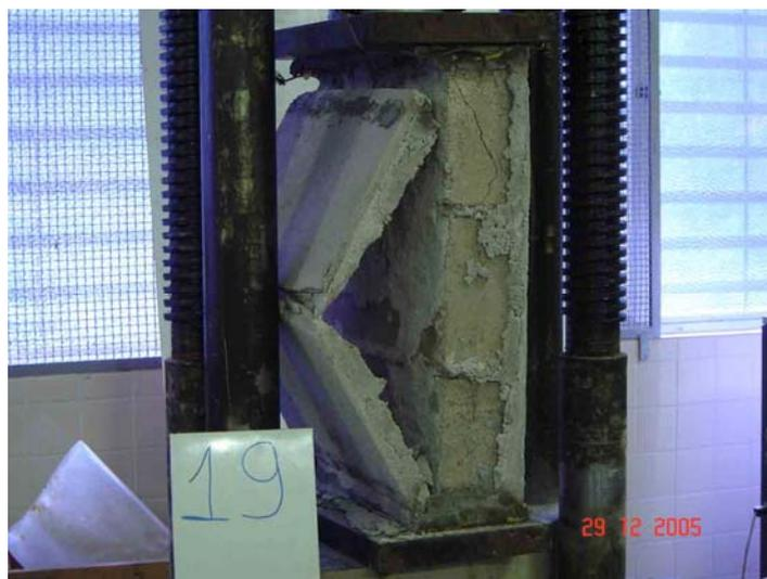
Figura 5. 8 - Ruptura com fissura diagonal, por cisalhamento e descolamento do revestimento e ruptura do mesmo por flexo-compressão (Tipo 3.3)
