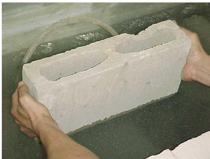
Figura 3. 6 - Imersão em água do bloco de concreto a uma altura de 3 mm durante 1 minuto
