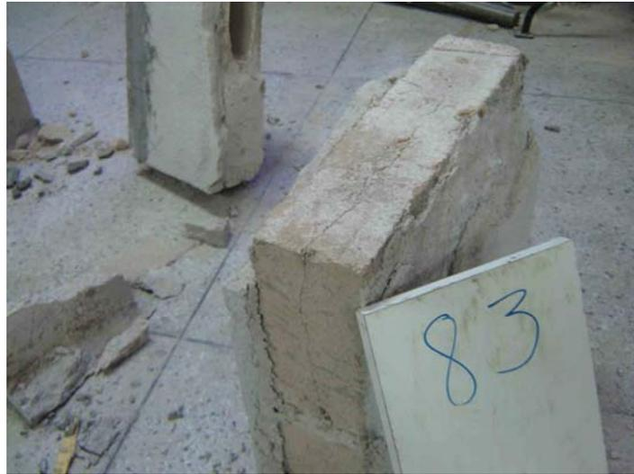
Figura 5. 16 - Prisma desmontado com fissura propagada pelo bloco
