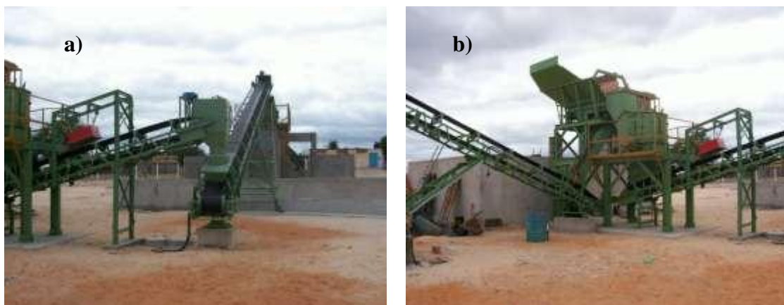
Figura 2.3 – Máquinas e Equipamentos da Usina de RCD de Petrolina-PE. a) Vista do eletroímã e correias transportadoras; b) Vista parcial do britador. Fonte: O Autor (2008).
