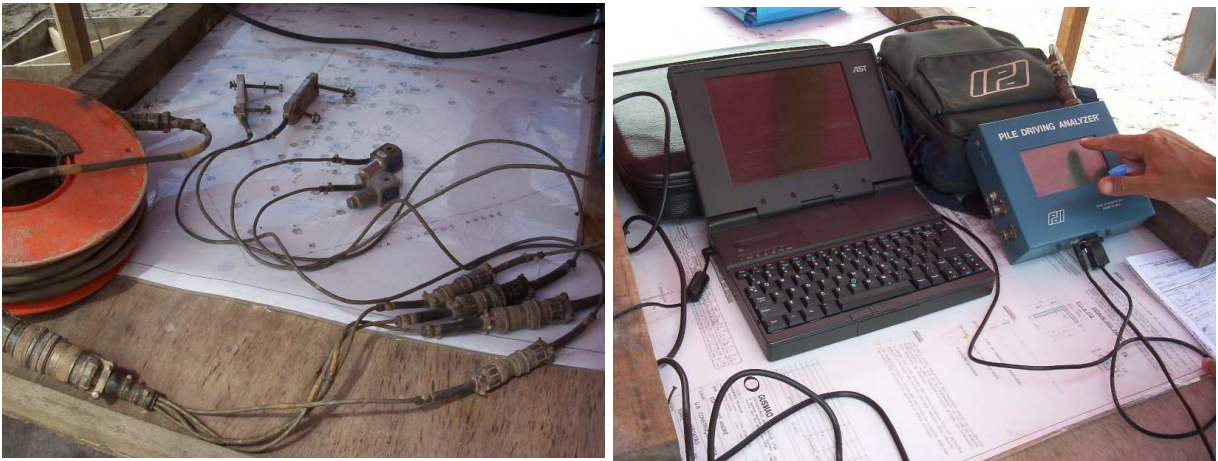
Figura 3.11 – (a) Transdutores e acelerômetros utilizados no ensaio (b) Equipamento P.D.A.(Pile driving analyser)
