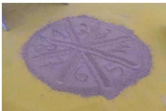
Figura 3.4 – Quarteamento dos RCD usados para obtenção das amostras
