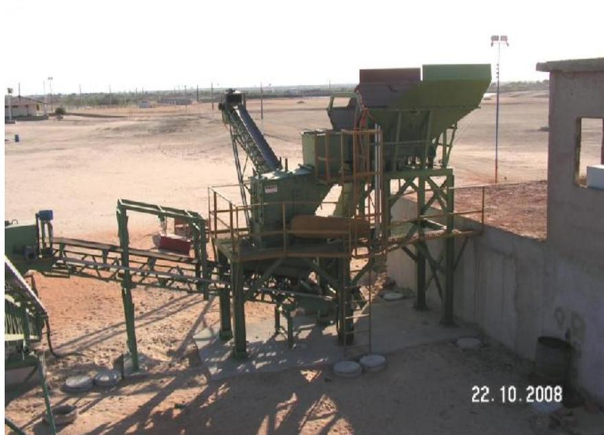
Figura 2.11 - Vista panorâmica superior leste do alimentador vibratório, britador de impacto, transportador de correia fixo, imã e estrutura metálica de sustentação.
