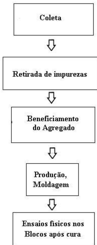
Figura 3.1 – Fluxograma: Parte experimental do trabalho
