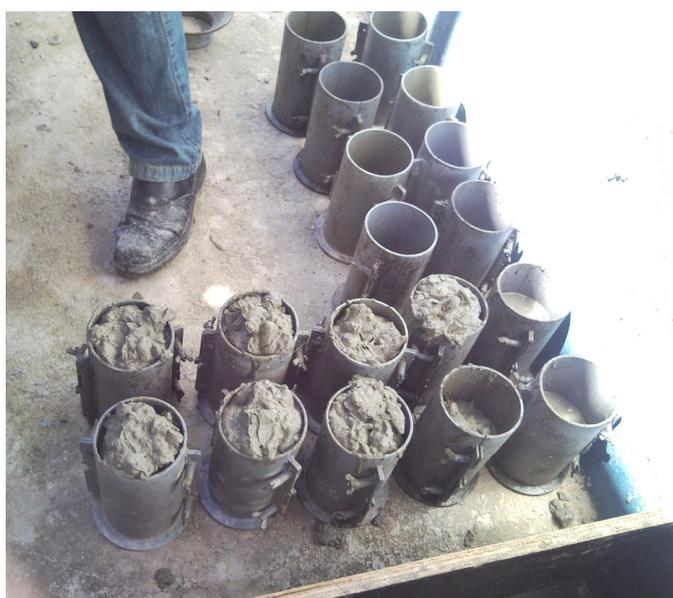
**Figura 29 - Moldagem dos corpos de prova**
