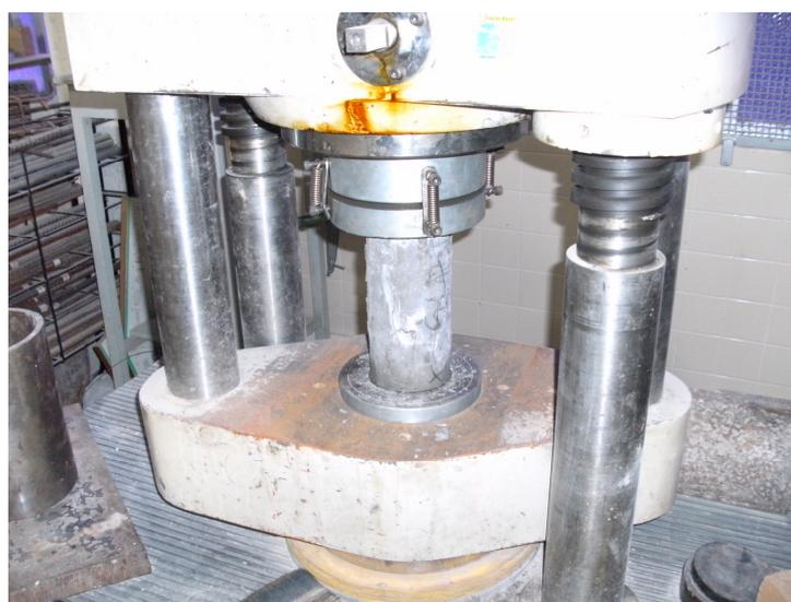
**Figura 33 - Ensaio de Resistência à compressão**
