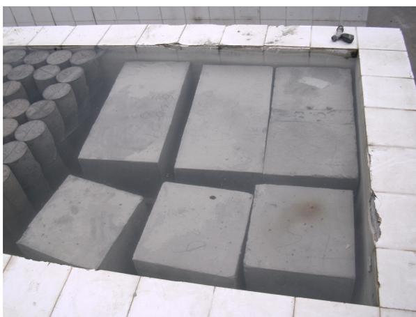
**Figura 31 - Corpos de prova e prismas no tanque de cura**
