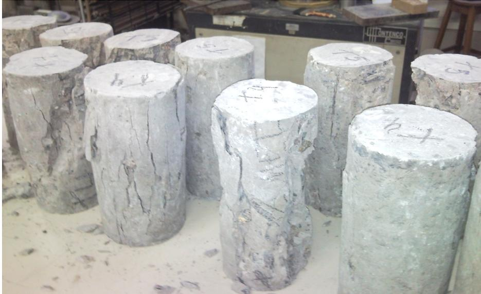
**Figura 34- Corpos de prova cilíndricos rompidos à compressão**
