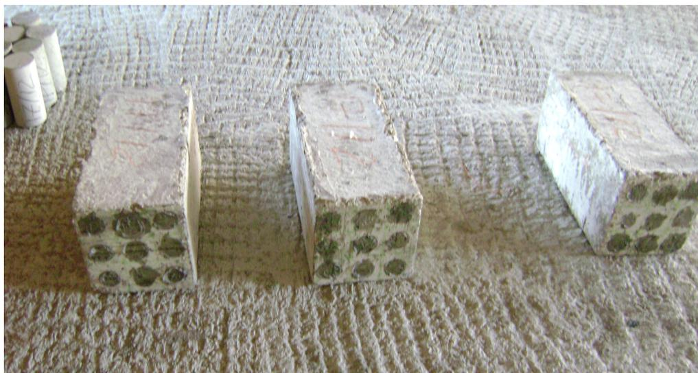
**Figura 37 - Corpos de prova prismático após a realização dos ensaios de ultrassom**
