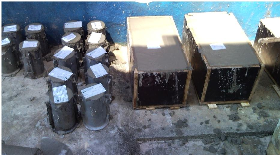
**Figura 30 - Moldagem dos corpos de prova cilíndricos e prismáticos**
