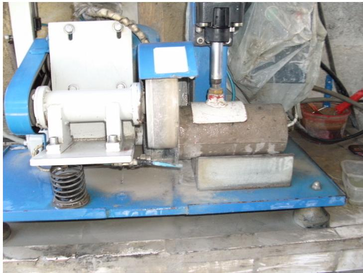
**Figura 32 - Retificação do corpo-de-prova**
