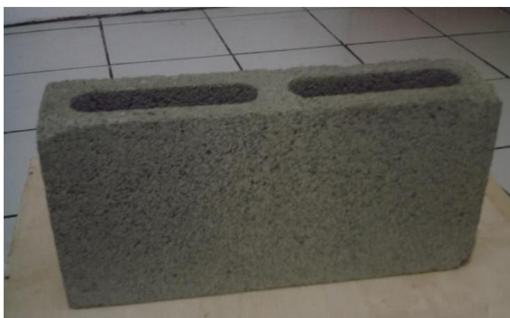
**Figura 4.4.2-1- Bloco de concreto utilizado para execução dos painéis, com as dimensões de 90 mm x190 mm x390 mm**
