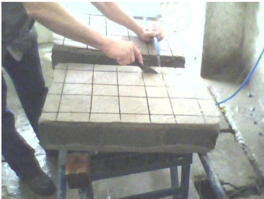
**Figura 4.6.4-7 Eliminação dos resíduos deixados durante o corte úmido**
