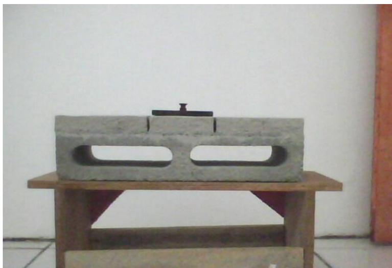
**Figura 4.12.1-1 Dispositivo metálico para execução do ensaio de tração normal ( $90^\circ$ )**
