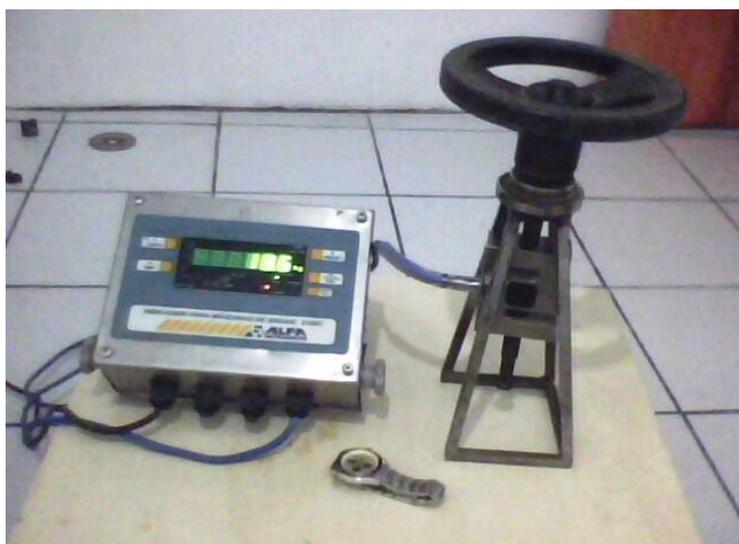
**Figura 4.9-1 Instrumento utilizado para a execução dos ensaios (Aderímetro)**
