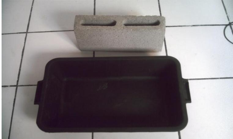
**Figura 4.6.1-1** Cuba plástica para preparação da argamassa de revestimento
