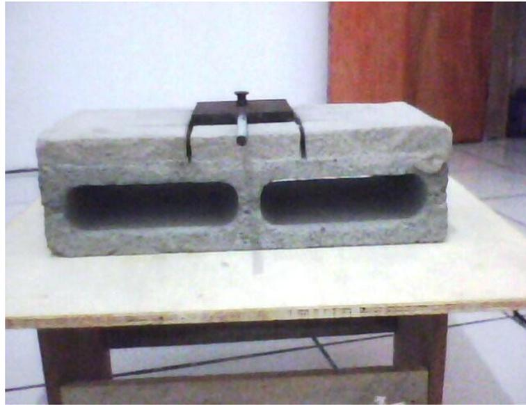
**Figura 4.12.3-2 Dispositivo metálico para realização do ensaio de cisalhamento (0°)- Vista frontal**
