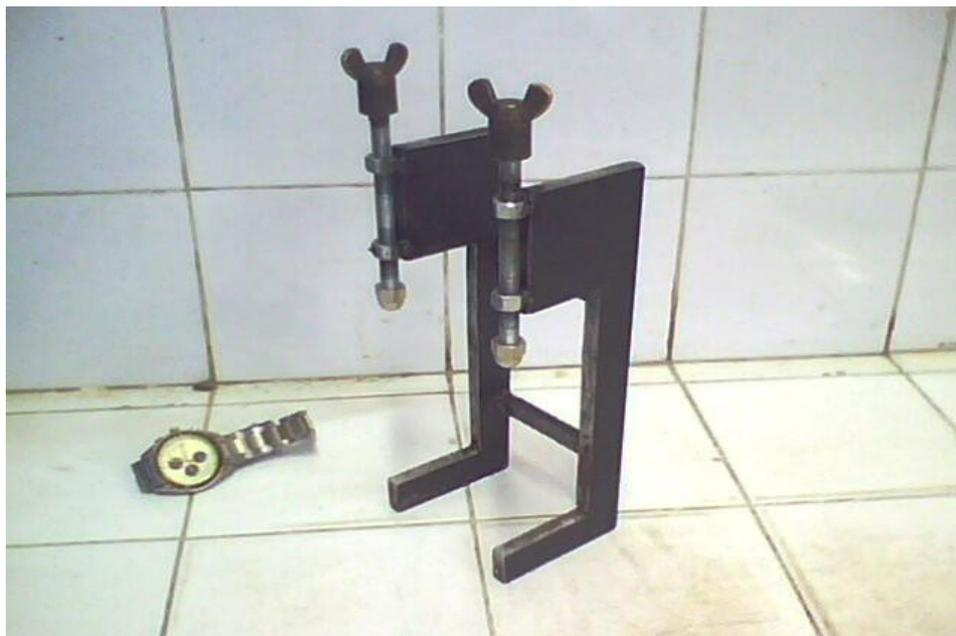
**Figura 4.2.1-2 Dispositivo metálico elaborado para procurar evitar a deformação observada no apoio de madeira (Figura 4.2.1-1)**
