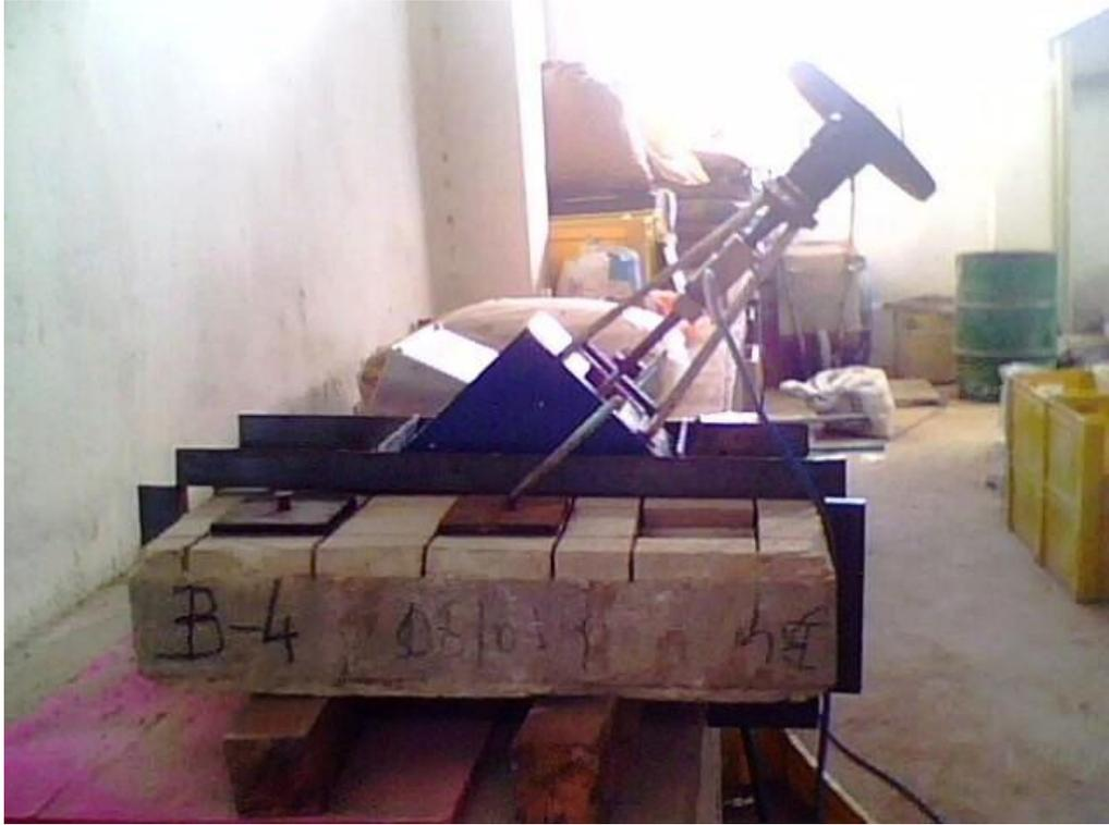
Figura 4.2.1-4 “Abraçadeira” – Vista lateral - Execução do ensaio a 45°
