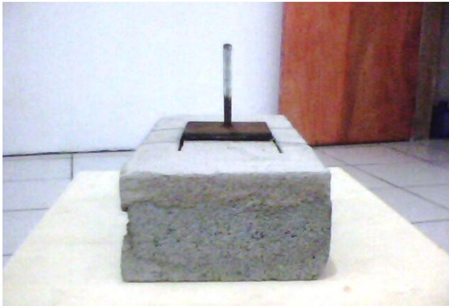
**Figura 4.12.2-2 Dispositivo metálico para realização do ensaio oblíquo (45°)-Vista frontal**
