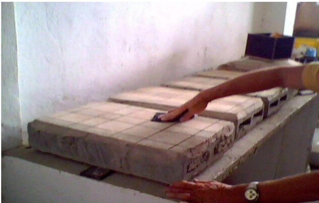
**Figura 4.6.4-8 Lixamento das superfícies dos corpos-de-prova**
