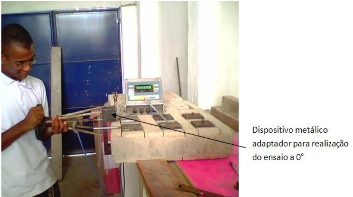
**Figura 4.12.3-3 Execução do ensaio de cisalhamento (0°)**
