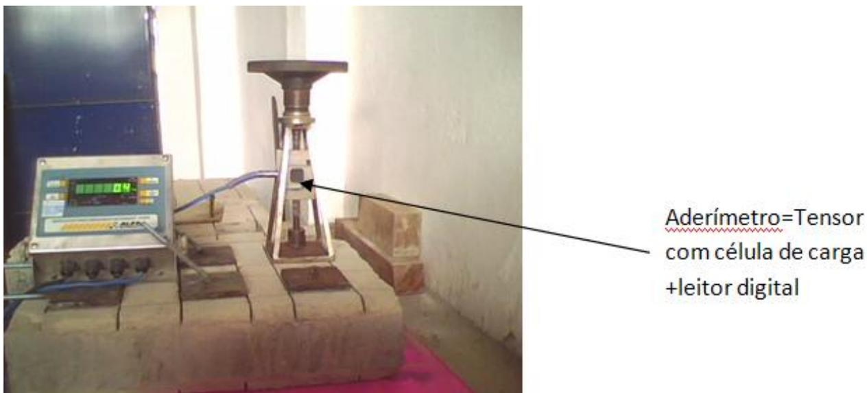
**Figura 4.12.1-2 Execução do ensaio de tração normal (90°)**
