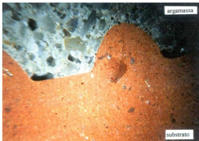
**Figura 3.2-2 Argamassa aplicada com perfeita adesão nas reentrâncias do bloco cerâmico (CARASEK, 1996)**
