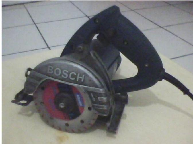
**Figura 4.6.4-3 Máquina serra mármore para utilizada no corte do revestimento**
