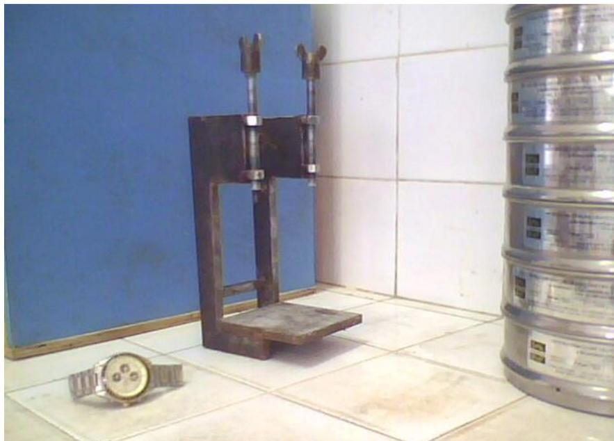
**Figura 4.12.3-3 Dispositivo metálico adaptador para realização do ensaio de cisalhamento (0°)**
