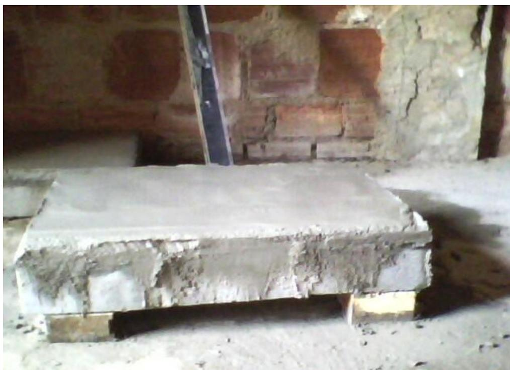
**Figura 4.2-2 Preparação do painel de bloco de concreto para o Ensaio-piloto**
