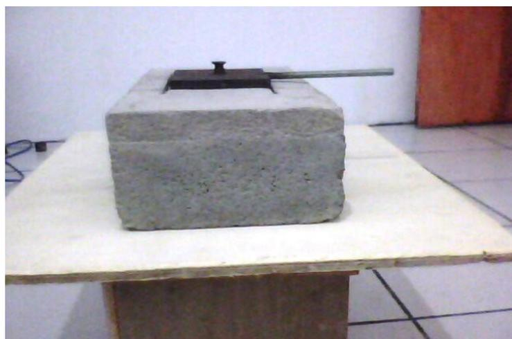
**Figura 4.12.3-1 Dispositivo metálico para realização do ensaio de cisalhamento (0°)-
