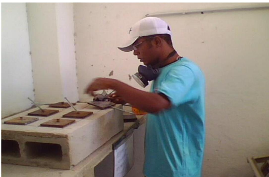
**Figura 4.6.4-9 Colagem dos dispositivos metálicos sobre os corpos de prova**
