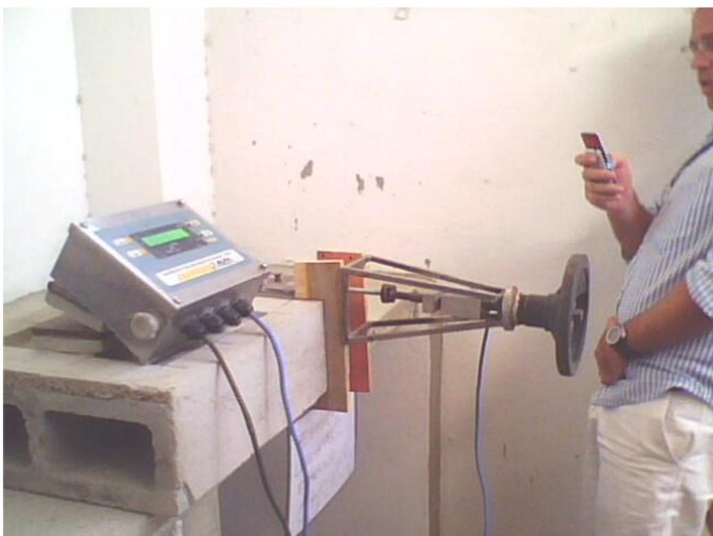
**Figura 4.2.1-1 A madeira vista na figura apresentou deformação quando da execução do ensaio de cisalhamento**
