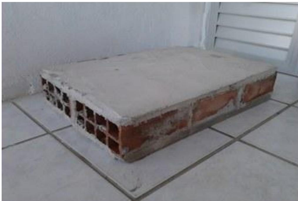
**Figura- 4.2-1 Painel de bloco cerâmico pronto para o Ensaio-piloto**
