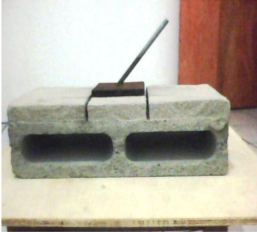
**Figura - 4.12.2-1 Dispositivo metálico para realização do ensaio oblíquo (45°)-Vista lateral**
