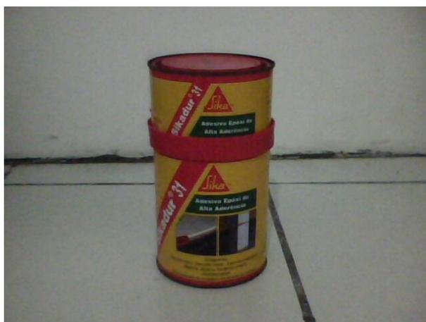
Figura 4.8-1 Adesivo bi-componente utilizado na colagem dos dispositivos metálicos
