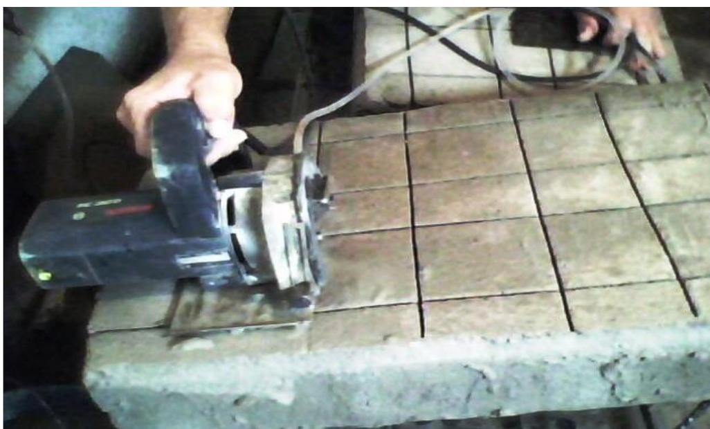
**Figura 4.6.4-6 Corte do revestimento do painel, delimitando-se os corpos-de-prova**
