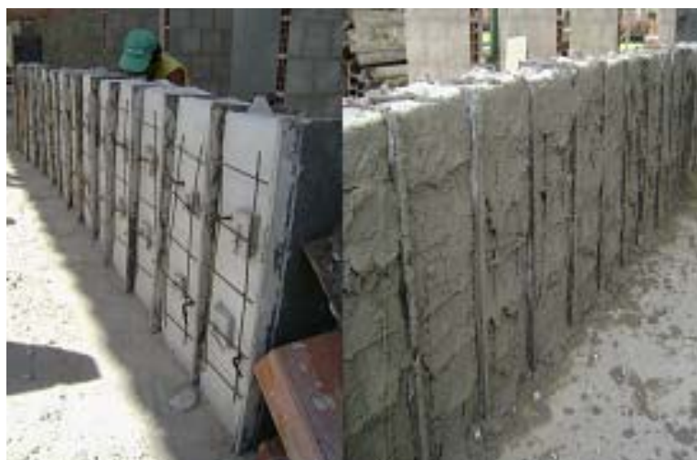
Figura 3.27 - Prismas com conectores e telas de reforço
