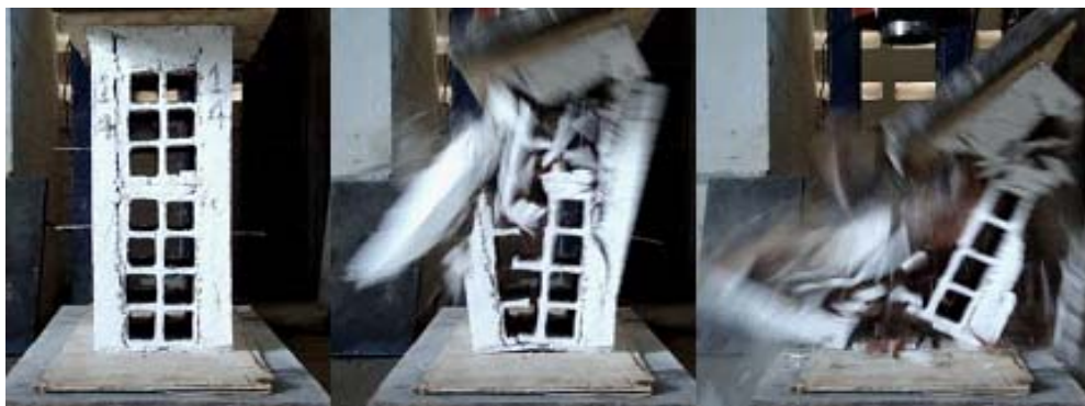
Figura 3.42 - Ruptura do prisma 2 blocos traço 1:2:9 revestimento 3 cm
