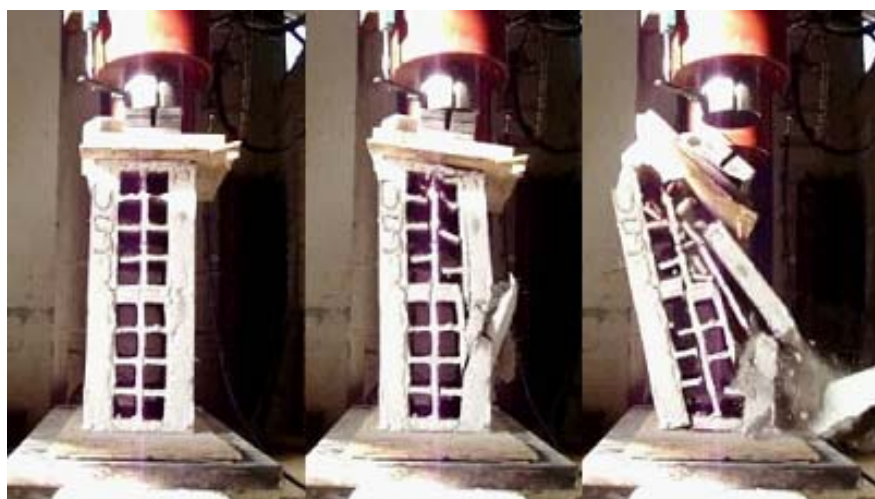
Figura 3.43 - Ruptura do prisma 2 blocos traço 1:1:6 revestimento 3 cm
