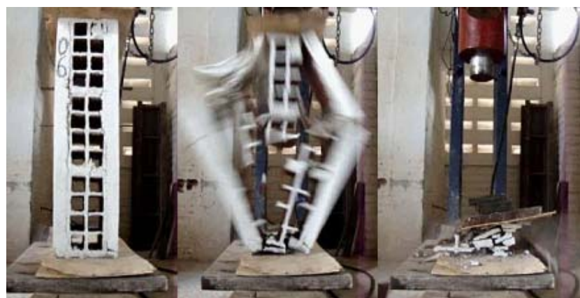
Figura 3.47 - Ruptura do prisma traço 1:2:9 revestimento 3 cm
