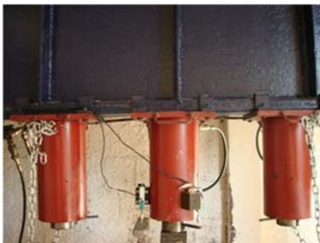
Figura 3.37 - Macacos utilizados na aplicação de carga
