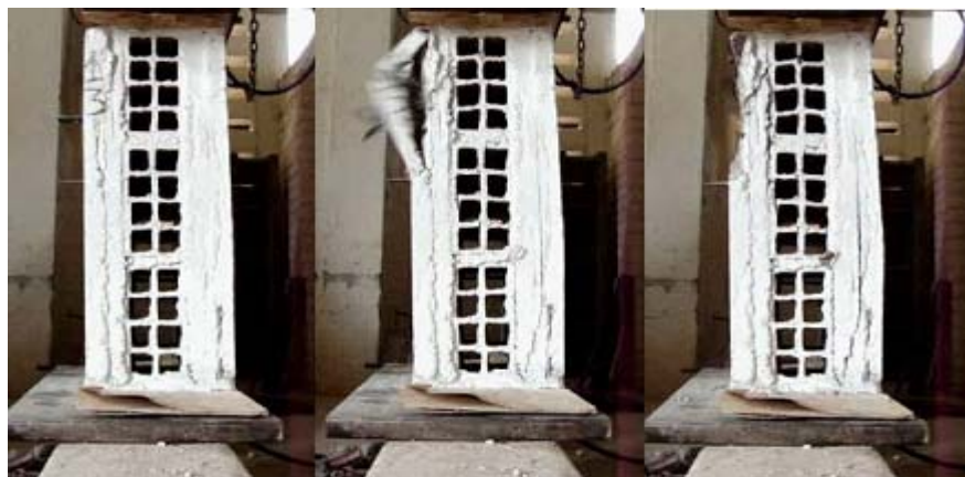
Figura 3.52 - Ruptura do prisma traço 1:1:6 revestimento 3,0 cm com reforço
