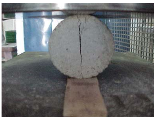
Figura 3.23 - Ensaio de resistência à tração por compressão diametral
