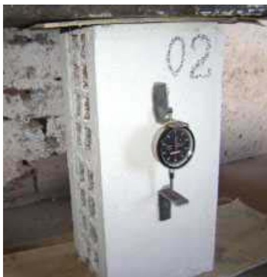
Figura 3.31 - Prismas com base de apoio dos deflectômetros colada
