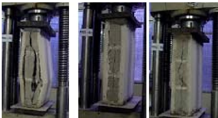
Figura 2.11 - Ruptura dos prismas com revestimento, com tela
