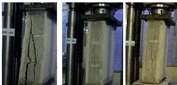
Figura 2.10 - Ruptura dos prismas de blocos de concreto com revestimento e sem tela
