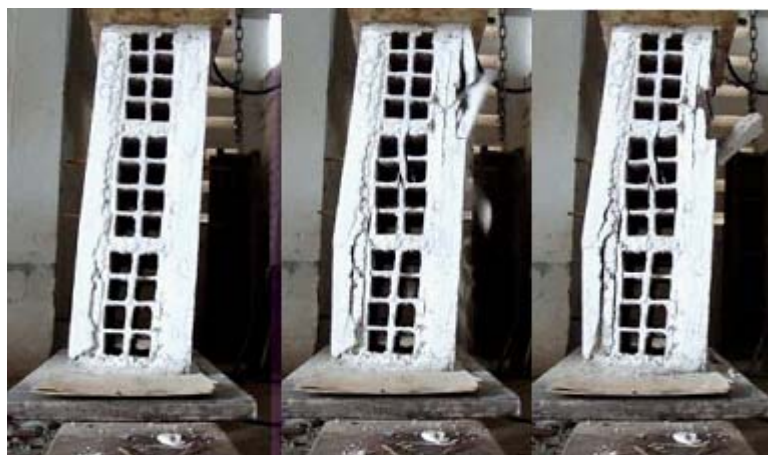
Figura 3.50 - Ruptura do prisma traço 1:2:9 revestimento 1,5cm com reforço
