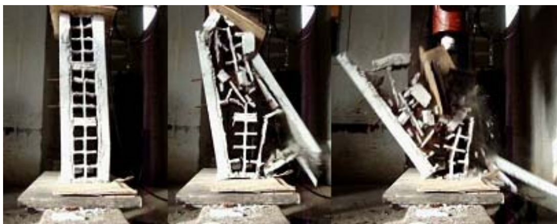
Figura 3.49 - Ruptura do prisma traço 1:0,5:4,5 revestimento 3,0 cm
