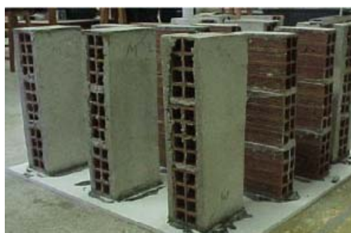
Figura 2.2 - Prismas de três blocos cerâmicos com e sem revestimento
