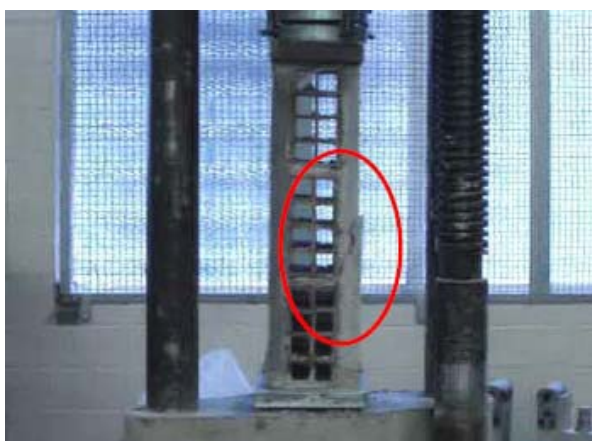
Figura 2.5 - Prismas de blocos cerâmicos com revestimento: ruptura por cisalhamento
