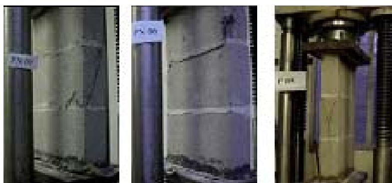
Figura 2.9 - Ruptura dos prismas de blocos de concreto sem revestimento
