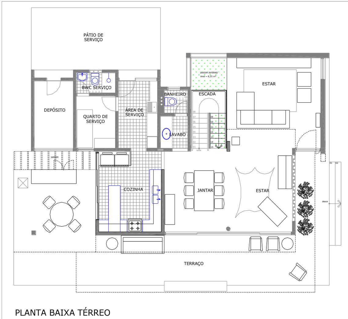
Figura 29: Planta Baixa Pavimento Térreo.
