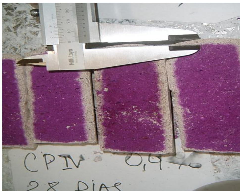
Ilustração 19 – Aferição da profundidade de carbonatação utilizando PAQUIMÉTRO
