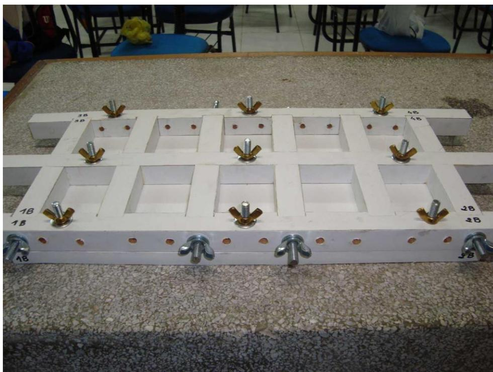
**Ilustração 7 – Forma utilizada para confecção de corpo-de-prova prismático**
