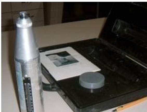
**Figura 3.9 - Esclerômetro de reflexão**
