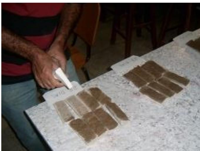
**Figura 3.11 - Aplicação do nitrato de prata nos corpos-de-prova**
