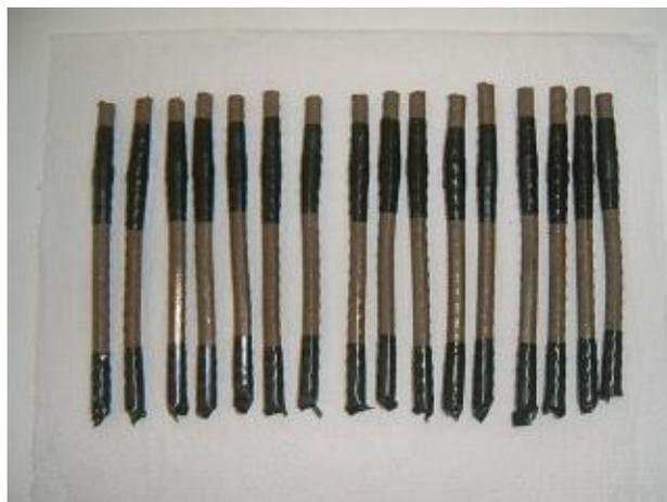
Figura 3.2 - Formato do aço tipo CA - 50 utilizados no experimento
