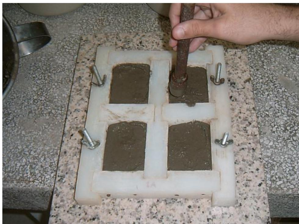
**Ilustração 8 – Moldagem do corpo de prova prismático**
