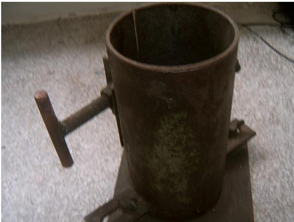
**Ilustração 1 - Molde de 10cm x 20cm utilizado na preparação dos CP'S**
