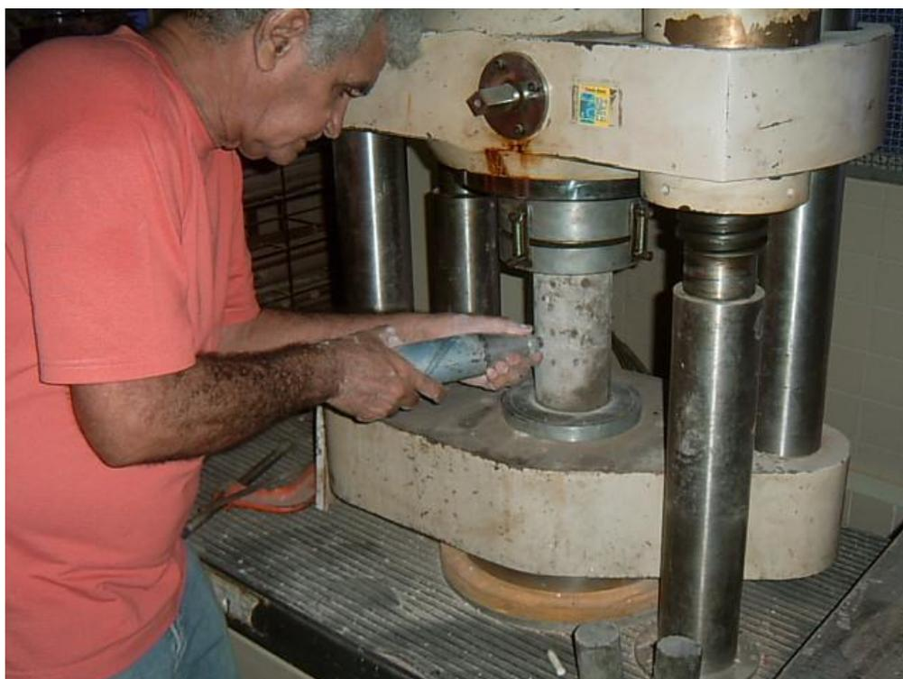
**Ilustração 15 – Aferição através do Esclerômetro de reflexão do tipo SCHIMIDT**
