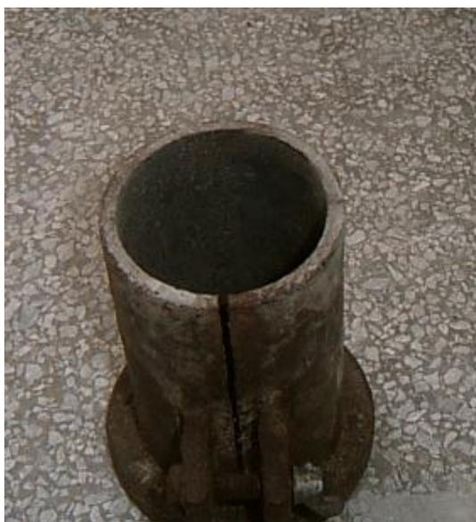
**Ilustração 2 - Molde de 5cm x 10cm utilizado na preparação dos CP'S**
