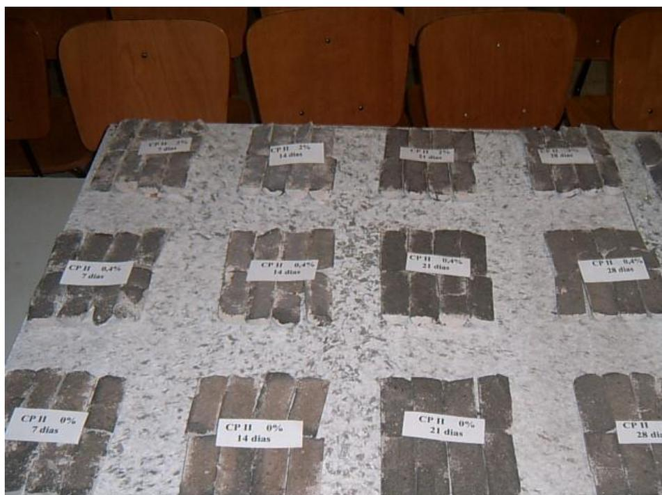
**Ilustração 18 – Corpos de prova seccionados com diversos teores de cloretos**
