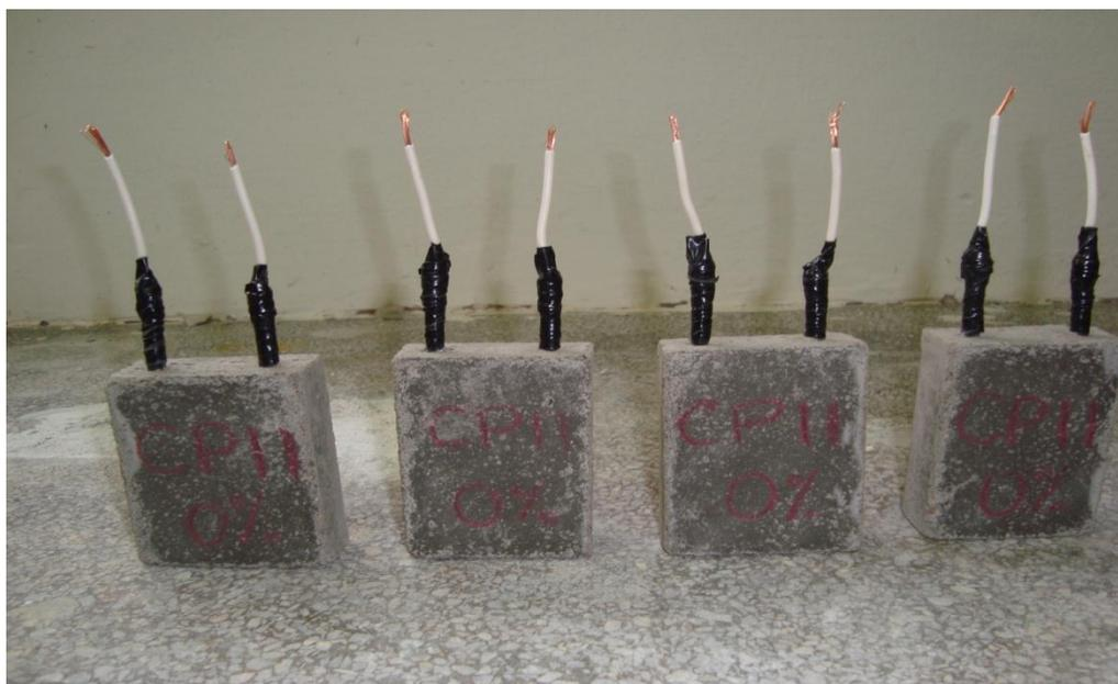
Figura 4.8 - Corpos-de-prova prismáticos utilizados nas leituras eletroquímicas
