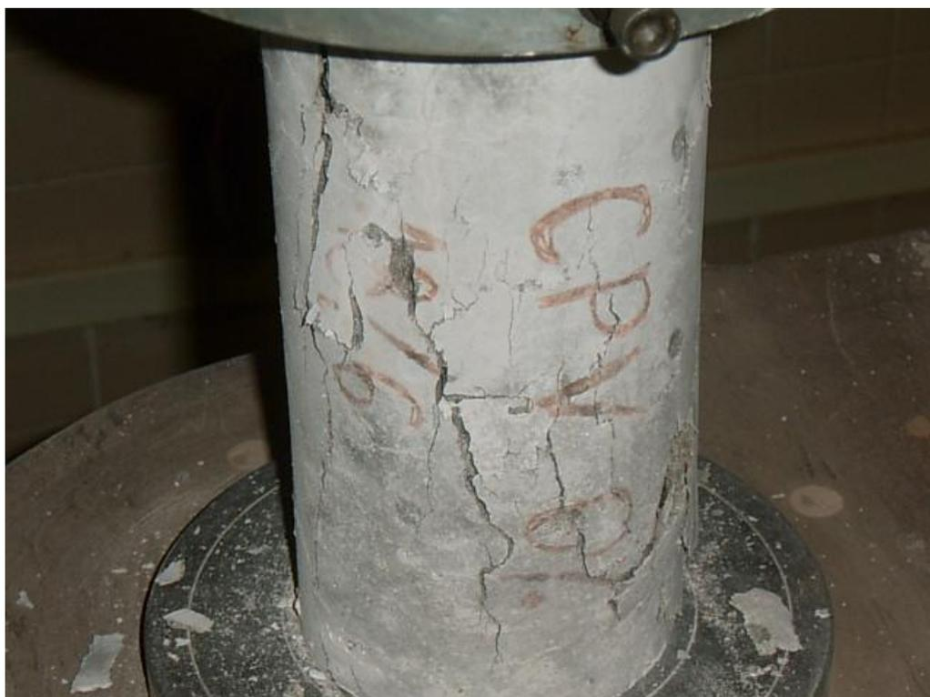
**Ilustração 16 - Ensaio de resistência a compressão utilizando a Máquina Universal -**
