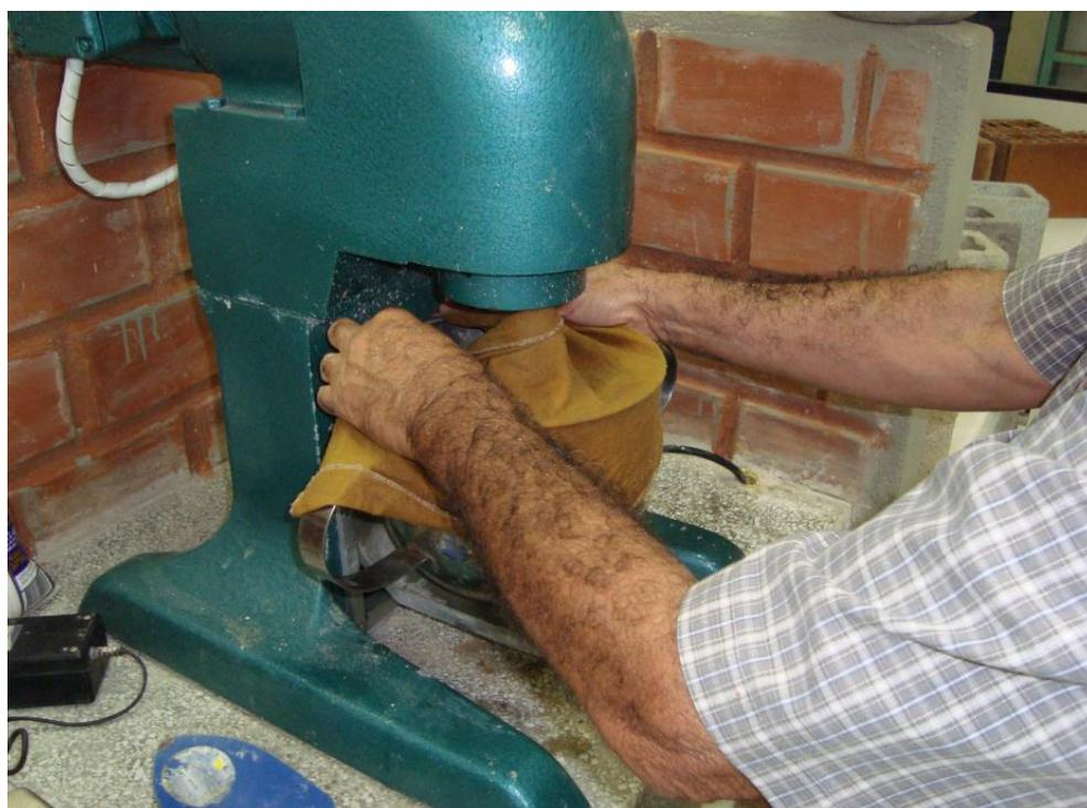
**Ilustração 4 – Moldagem dos corpos de prova no laboratório**
