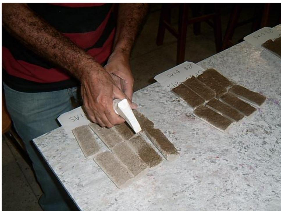
**Ilustração 17 - Aplicação de solução de nitrato de prata nos corpos de prova**
