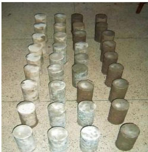
**Figura 3.7 - Corpos-de-prova utilizados no ensaio de resistência à compressão**
