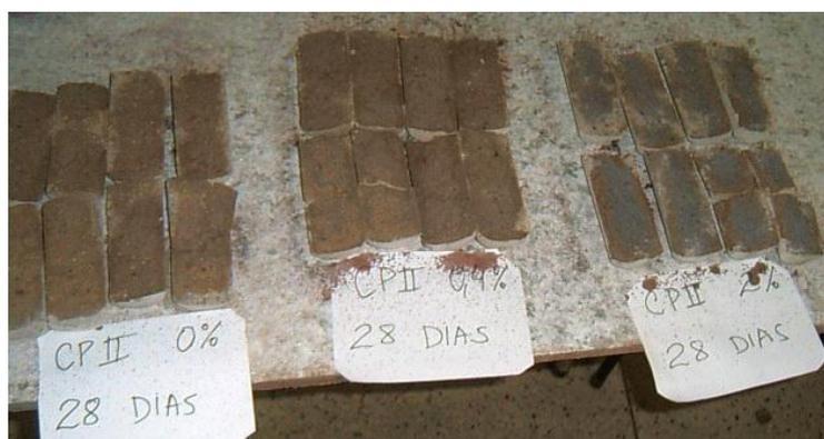
**Figura 3.12 - Avaliação da presença de cloretos nos corpos-de-prova**
