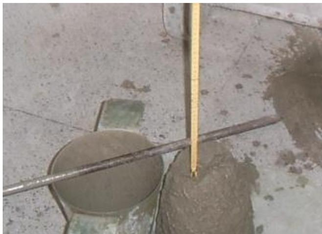
**Figura 3.6 - ensaio de abatimento (Slump Test)**
