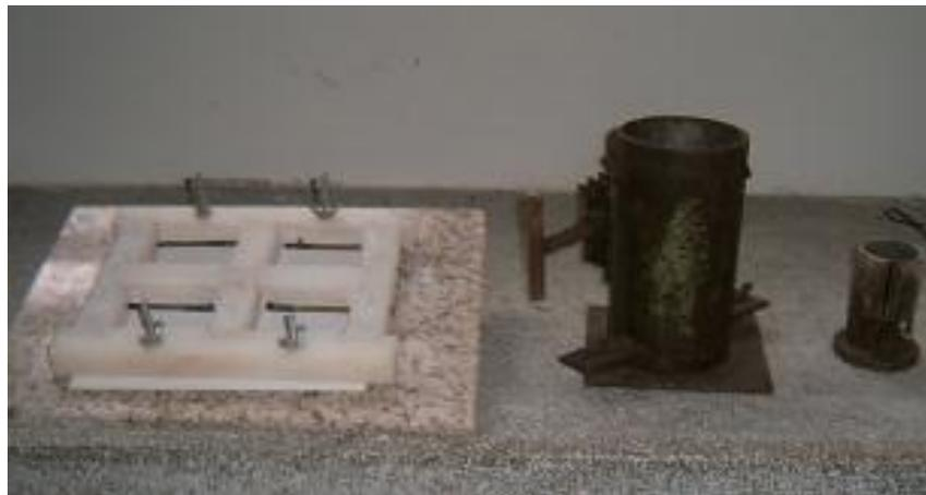
Figura 3.4 - moldes utilizados no preparo dos CP's
