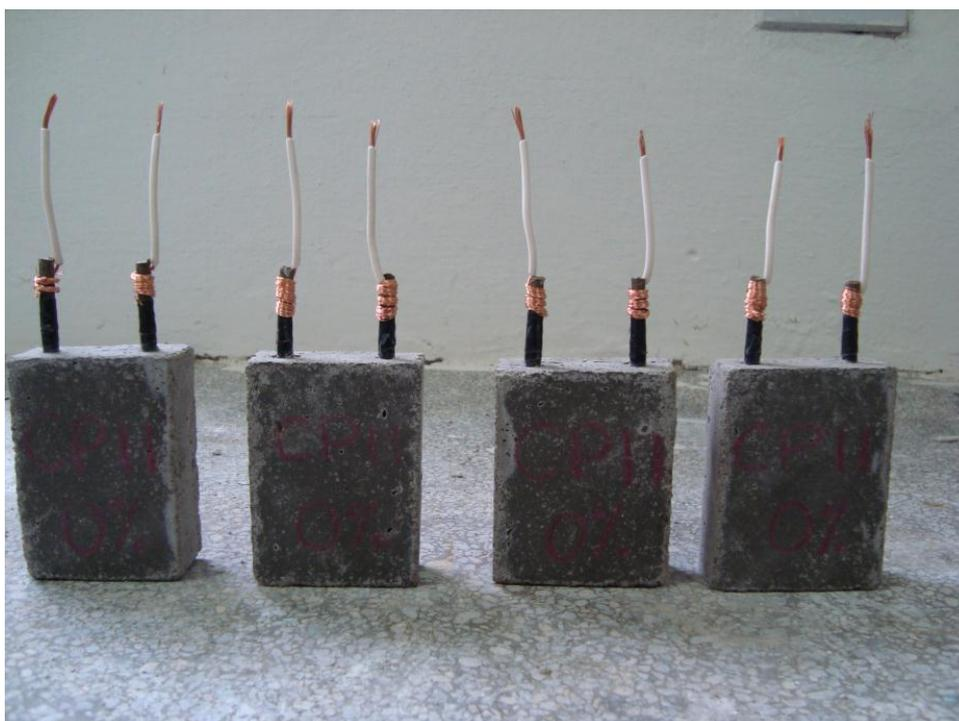
**Ilustração 11 – Preparação dos corpos-de-prova prismáticos para utilização nas leituras eletroquímicas**
