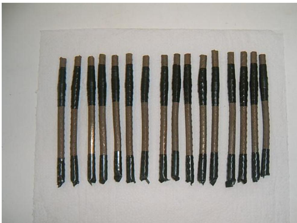
**Ilustração 5 – Formato do Aço tipo CA – 50 utilizado no experimento**
