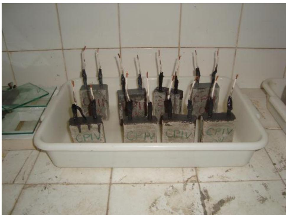
**Ilustração 12 – Os corpos de prova prismático alojados no laboratório, utilizados nas leituras eletroquímicas**
